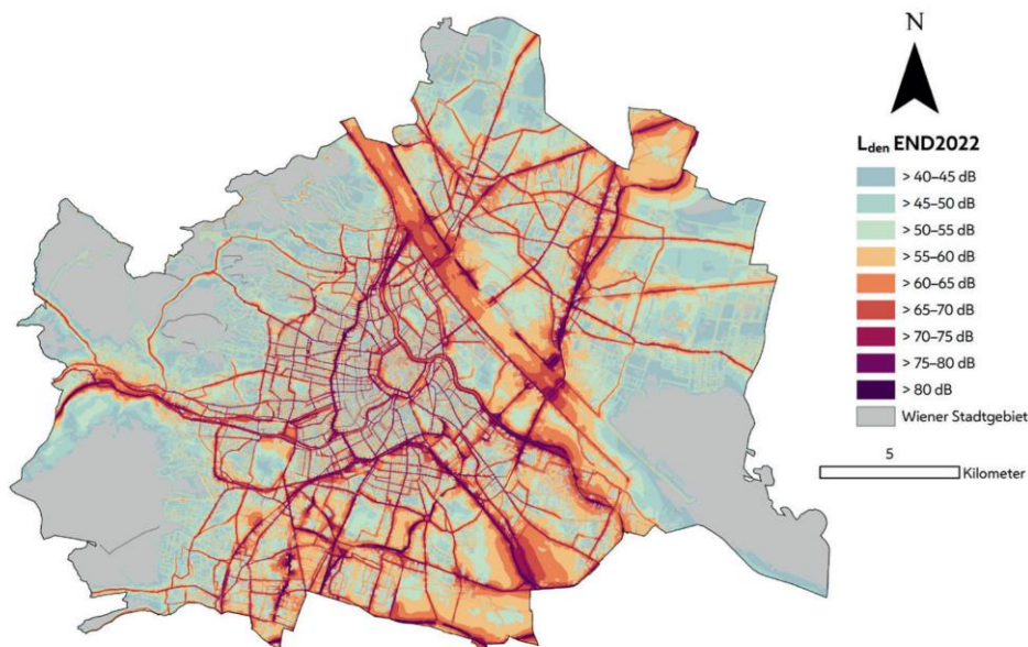
Abbildung 31: Strategische Lärmkarte Wiens, basierend auf der END2022 (MA 22, 2022); Quelle: (Stadt Wien - Umweltschutz, 2022, S.5)
