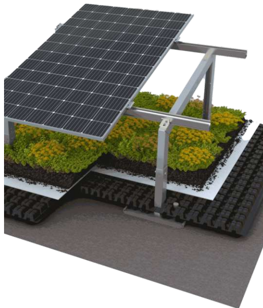
Abb. 141: Schnitt Solar Gründach
