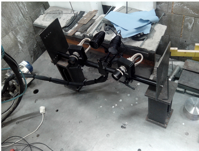
(a) Die 2 Kameras inklusive Beleuchtungsgruppe auf einer Unterkonstruktion montiert
