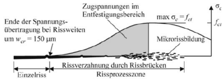
Abb. 2.10: Spannungsverteilung in der Rissprozesszone, im Entfestigungsbereich ist auch nach Erreichen der Zugfestigkeit f_{ct} eine Übertragung von Zugspannungen möglich, nach [35]
