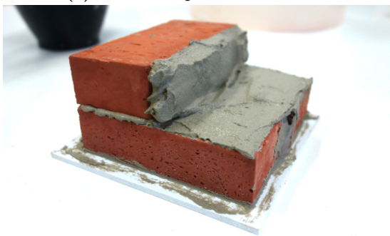
(e) Stoßfugenverfüllung vor dem zweiten Stein
