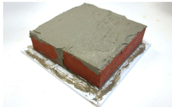
(d) Unterste Mauersteinschar
