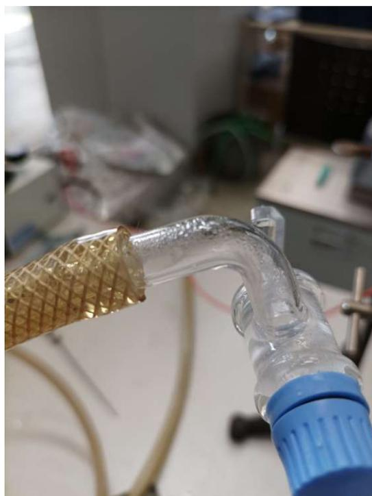
Abbildung 97: Kondensatbildung am Ausgang des Dehydrationskolben
