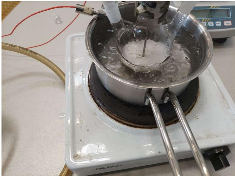
Abbildung 99: Kalziumoxalat in Rundkolben und Wasserbad (Versuch 3)
