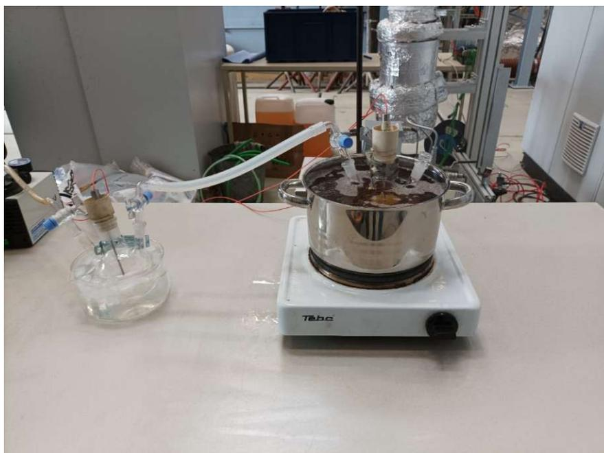
Abbildung 50: Modifizierter Versuchsaufbau (Oxalat in Thermoölbad)
