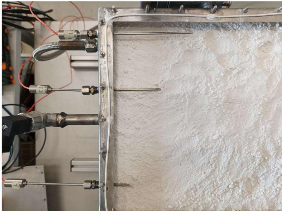
Abbildung 100: Position der Temperaturfühler der Temperaturmessung des Versuchstandes
