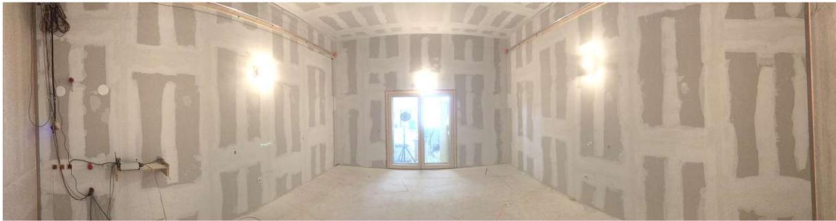
**Abb. 3.8:** Raumkonfiguration 'SR00' aus Blickrichtung des Prüfbauteils im XL-Prüfstands des ACA. Alle akustischen Element wurde entfernt, lediglich der Arbeitstisch (links) verblieb im Senderaum
