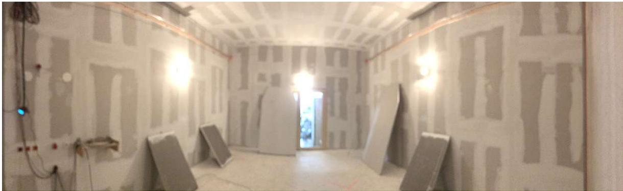
**Abb. 3.12:** Raumkonfiguration 'SR02' aus Blickrichtung des Prüfbauteils im XL-Prüfstands des ACA. Es kommen drei kleine Diffusoren mit je einer Fläche von  $1,0\text{ m}^2$  ( $0,8\text{ m}$  auf  $1,25\text{ m}$ ) sowie zwei große Diffusoren mit Abmessungen von  $1,25\text{ m}$  auf  $2,40\text{ m}$  zum Einsatz
