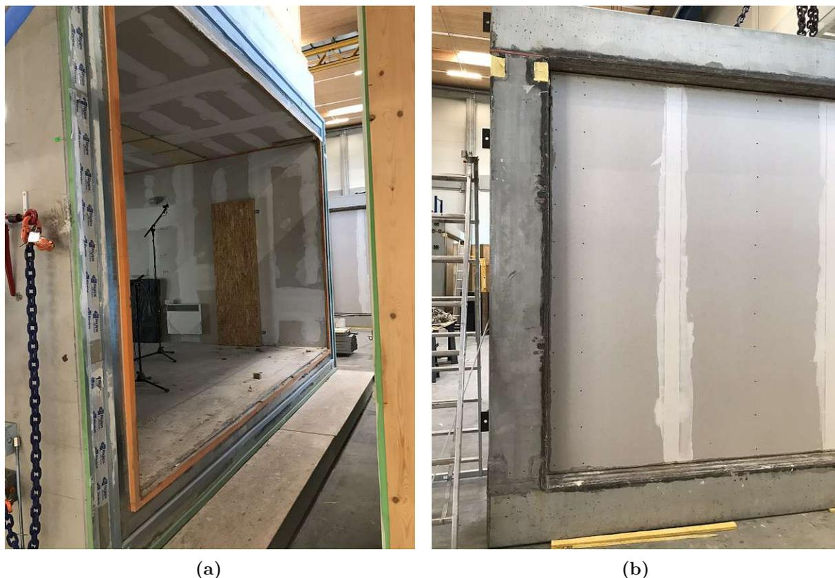
**Abb. 3.2:** Fotos des Prüfstands im ACA (a) Empfangsraum des geöffneten Prüfstands mit Elastomerlagern (orange und grün) zur akustischen Trennung des Prüfrahmens zu den Prüfräumen sowie (b) Foto des verwendeten Stahlbeton-Prüfrahmens mit eingebautem Prüfbauteil
