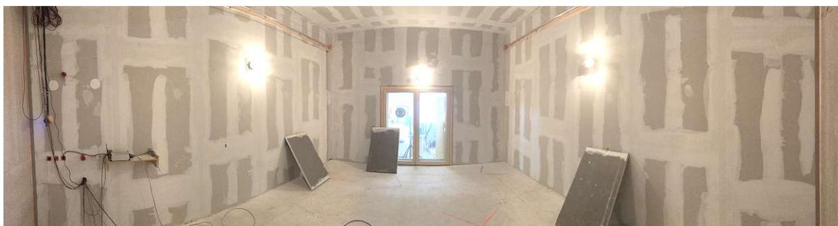
**Abb. 3.11:** Raumkonfiguration 'SR01' aus Blickrichtung des Prüfbauteils im XL-Prüfstands des ACA. Der leere Prüfraum wird mit drei Diffusoren mit je  $1,0 \text{ m}^2$  Fläche ergänzt
