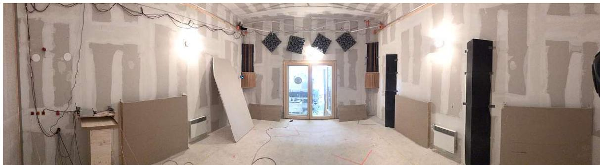
**Abb. 3.7:** Raumkonfiguration 'SRnorm' aus Blickrichtung des Prüfbauteils im XL-Prüfstands des ACA. Mit Plattenresonatoren und passiven Absorbern aus Schaumstoff an den Längswänden, Diffusoren an der linken Längswand sowie an der Rückwand, Bassfallen aus Holz und Akustikschaum in den Ecken sowie Schröderdiffusoren über der Türe
