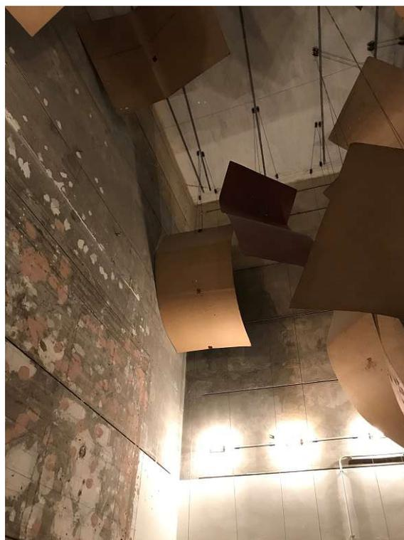
(b) Diffusoren aus Stahlblech sowie Holzfaserplatten im Hallraum des TGM Wien
