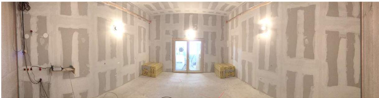
**Abb. 3.9:** Raumkonfiguration 'SR10' aus Blickrichtung des Prüfbauteils im XL-Prüfstands des ACA. Es werden in den leeren Senderaum Absorberpakete mit je  $1,2 / 0,9 / 0,6 \text{ m}^3$  in den Ecken der Rückwand platziert
