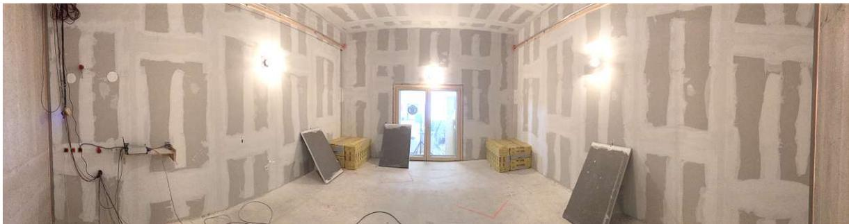
**Abb. 3.13:** Raumkonfiguration 'SR11' aus Blickrichtung des Prüfbauteils im XL-Prüfstands des ACA. Eine Kombination aus Absorberpaketen in den Ecken der Rückwand mit je  $1,2 / 0,9 / 0,6\text{ m}^3$  sowie der kleinen Diffusoren mit Abmessungen von  $0,8\text{ m}$  auf  $1,25\text{ m}$
