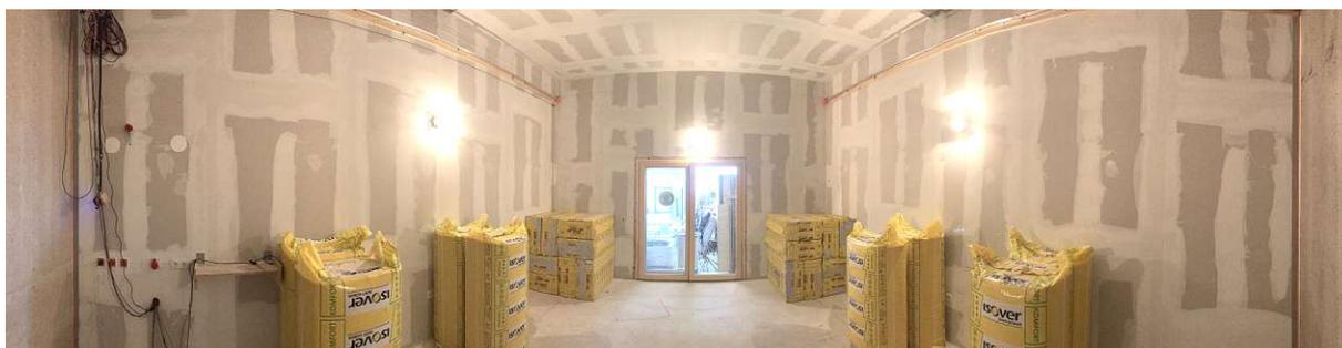
**Abb. 3.10:** Raumkonfiguration 'SR20' aus Blickrichtung des Prüfbauteils im XL-Prüfstands des ACA. Es finden sich Absorberpakete mit je  $1,2 / 1,2 / 1,2 \text{ m}^3$  in den Ecken der Rückwand sowie an den Längswänden vier Absorberpaket mit je  $0,6 / 1,0 / 1,2 \text{ m}^3$
