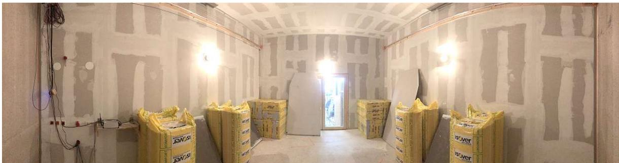
**Abb. 3.14:** Raumkonfiguration 'SR22' aus Blickrichtung des Prüfbauteils im XL-Prüfstands des ACA. Als Kombination der Absorberpakete in würfelform mit  $1,2\text{ m}$  Kantenlänge in den Ecken der Rückwand, vier Absorberpaketen entlang der Seitenwände mit je  $0,6 / 1,0 / 1,2\text{ m}^3$ , drei kleinen Diffusoren mit je  $1,0\text{ m}^2$  Fläche sowie zwei großen Diffusoren mit Abmessungen von  $1,25\text{ m}$  auf  $2,40\text{ m}$
