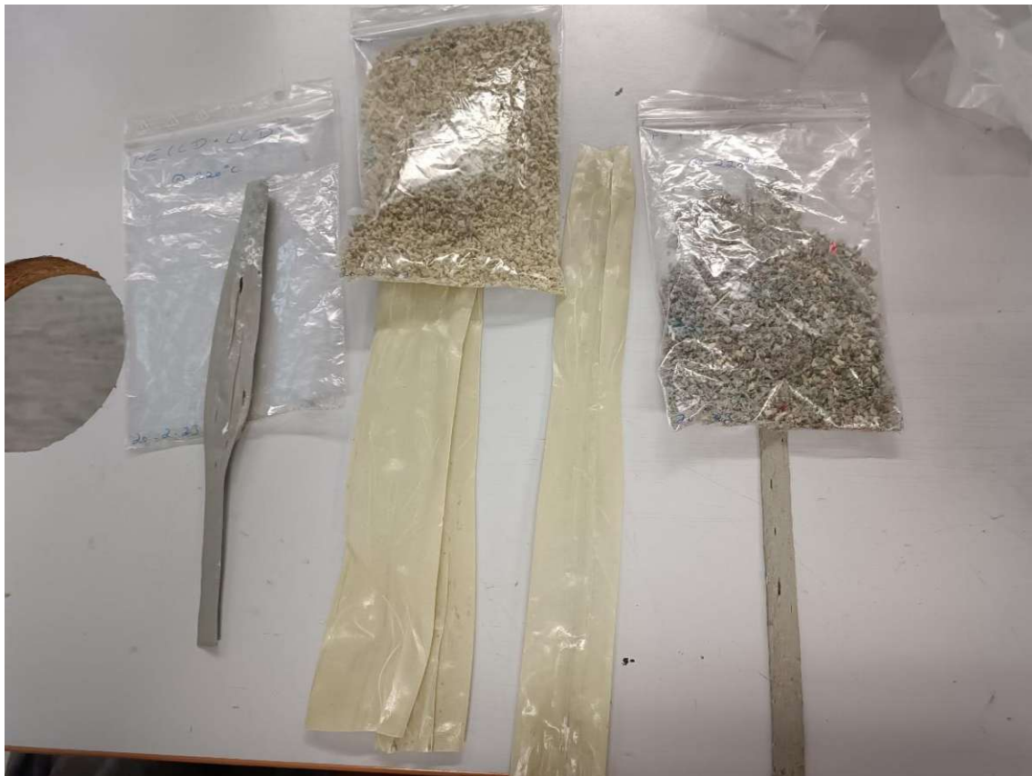
Abbildung 44: Folienblasen, links: PE, mittig: PP, rechts: PE+PP
