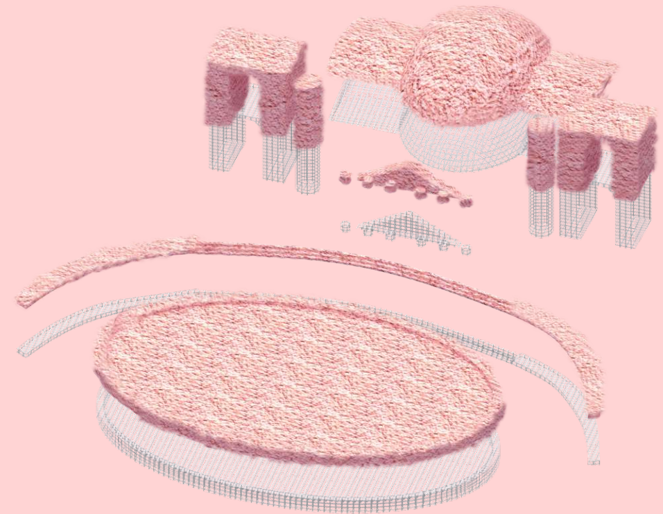
Abb. 136: Axonometrie, Stahlgitter Unterkonstruktion mit Bauschaum besprüht
