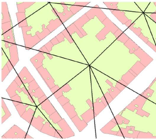
Abbildung 10: Delaunay Triangulierung basieren auf den Zentroiden der Baublöcke (Glawischnig 2016)
