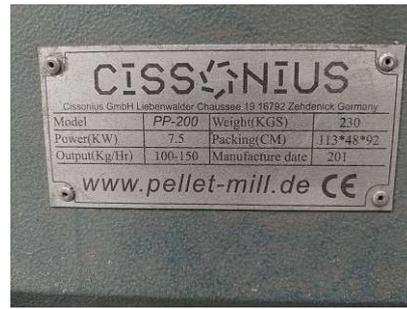
Fig. 20.: Data of the pellet press
