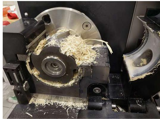
Fig. 16.: *Open cutting mill*
