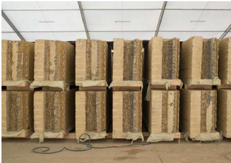
Abb. 67 oben: Wandaufbau des vorgefertigten Stampflehmelementes
