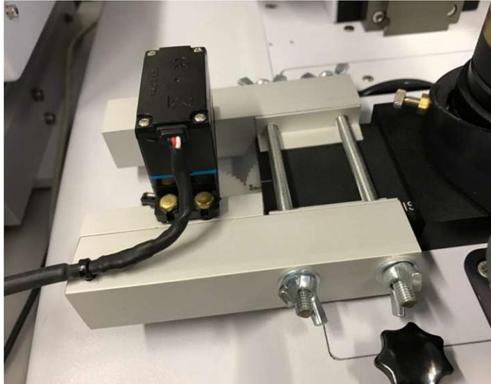
Abbildung 10: Motorhalterung am Polarisationsfilter
