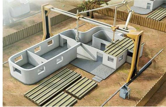
Abbildung 2: Grundmauern aus dem 3D Drucker (7)
