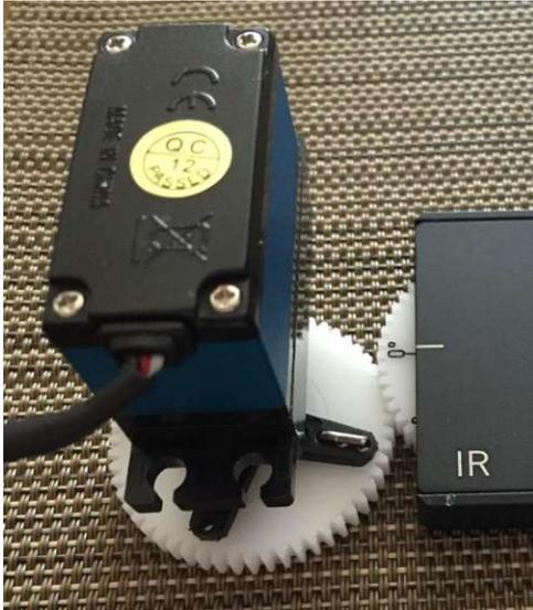
Abbildung 9: Servomotor mit Zahnrad an Polarisationsfilter
