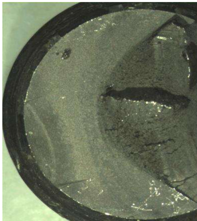
Abbildung 6: linsenförmige Dauerbruchfläche einer Schraube bei zyklischer axialer Beanspruchung. [9]
