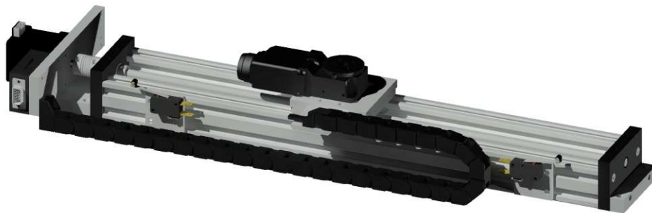
Abbildung 4.3: Probestisch der neuen Neutronenradiographiestation am TRIGA Mark-II Forschungsreaktor
