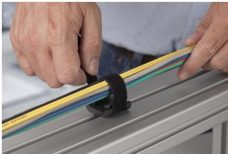
Abbildung 191: Anwendung des Universalhalters. Dieser wird mit Hilfe einer Senkschraube und einem Nutzenstein in der Profilnut befestigt.(item Industrietechnik GmbH 2016, S. 509)
