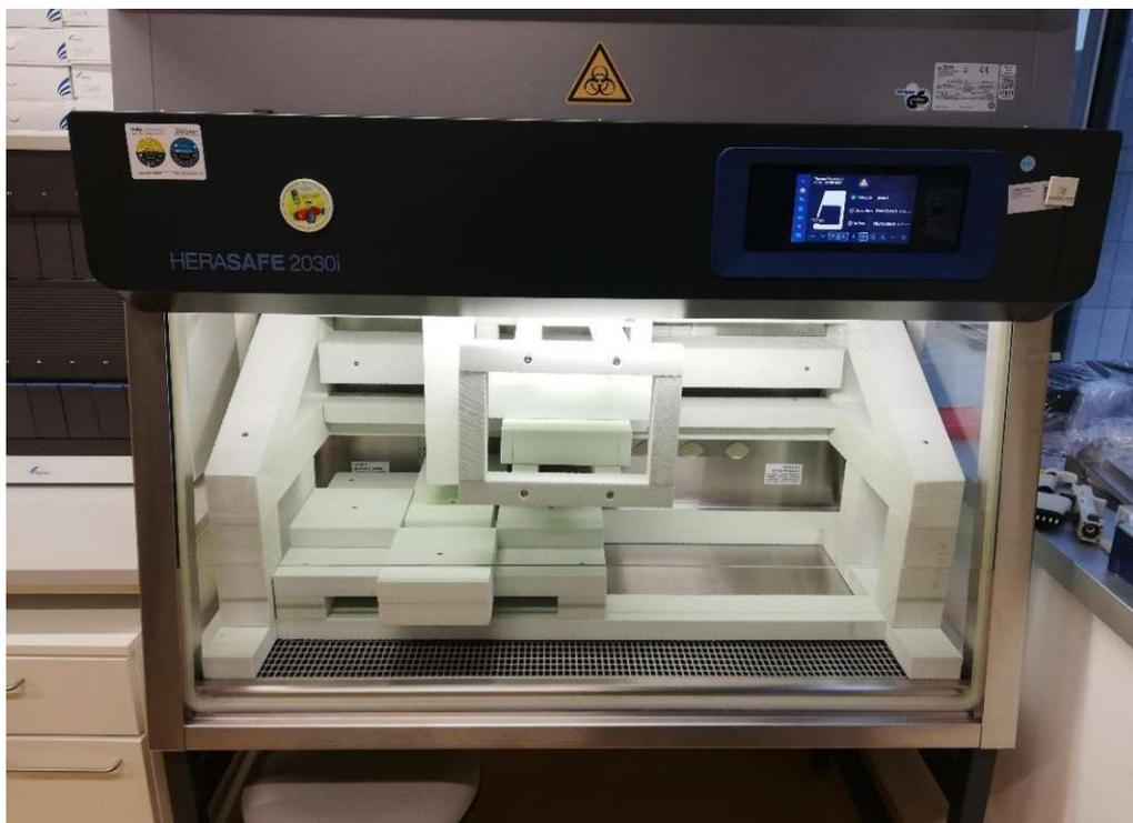
Abbildung 142: Vorfürmodell des vorläufigen Entwurfs 4C in Sicherheitswerkbank bei geschlossener Frontscheibe
