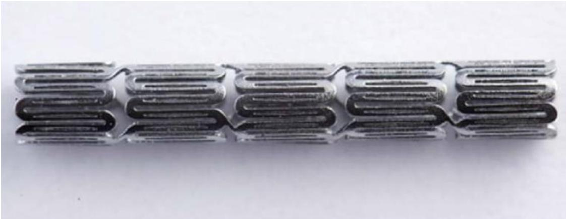
Abbildung 2: Ansicht eines Stents aus Nitinol. Gut sichtbar sind die längsförmigen Öffnungen zur temporären Aufnahme von Medikamenten (Hsiao et al. 2017, S. 12)
