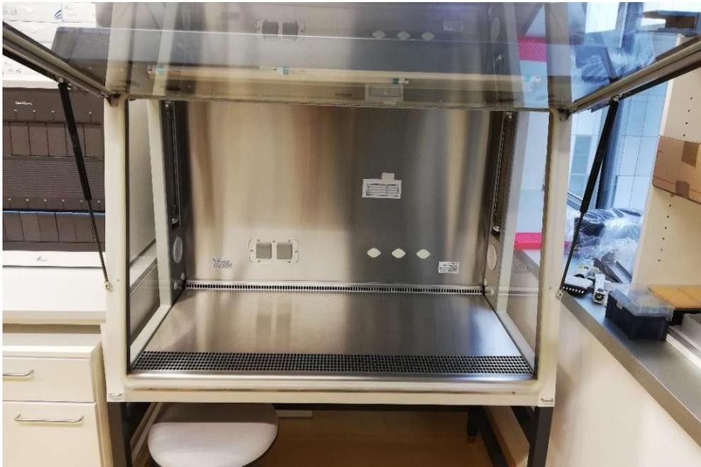
Abbildung 146: Ansicht des Arbeitsraums der Sicherheitswerkbank bei geöffneter Frontscheibe. Gut ersichtlich sind die Lüftungsöffnungen vorne und am hinteren Ende der Arbeitsplatte. Ebenfalls sind gut ersichtlich die beiden Gummitüllen ("Smart Ports") links und rechts in der Seitenwand.
