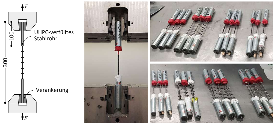
Abb. 3.3: Versuchsaufbau zur Bestimmung der Zugtragfähigkeit, angelehnt an [79].
