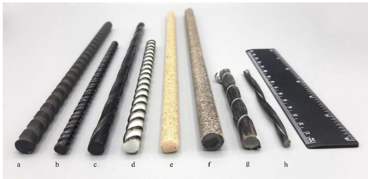
Abb. 2.2: Beispiele von Bewehrungsstäben mit unterschiedlicher Oberflächenbehandlung. (a) CFVK-Stab gerillt, (b) CFVK-Stab mit gedrehtem Carbon-Roving umwickelt, (c) CFVK-Stab mit flachem Carbon-Roving umwickelt, (d) GFVK-Stab mit gedrehtem Basalt-Roving umwickelt, (e) GFVK-Stab besandet, (f) BFVK-Stab besandet, (g) BFVK-Stab mit Faden umwickelt, (h) BFVK-Stab mit Faden umwickelt, entnommen aus [4].
