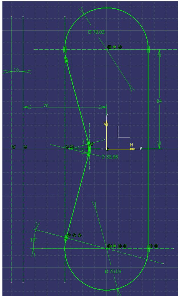
Abbildung 83: Darstellung der Riemenwirklänge in CATIA
