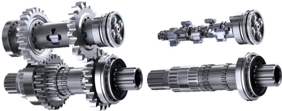
Abbildung 43: Schaltmechanismus des Pinion P1.18 beim eingelegten 7. Gang [25]
