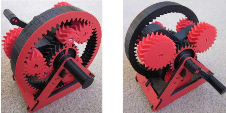
Abbildung 47: 3D-gedrucktes 7-Gang Planetengetriebe [30]
