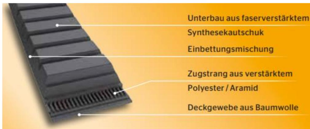
**Abbildung 29: Aufbau eines Breitkeilriemens [20]**
