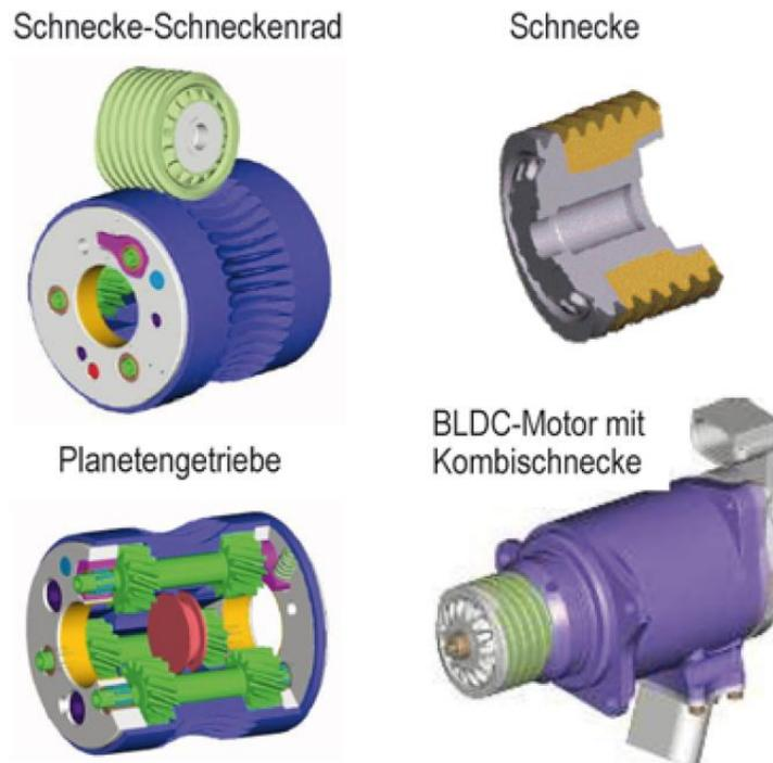
**Abbildung 19: Übersicht der einzelnen Komponenten der Differenzwinkeleinheit [6, S. 240]**
