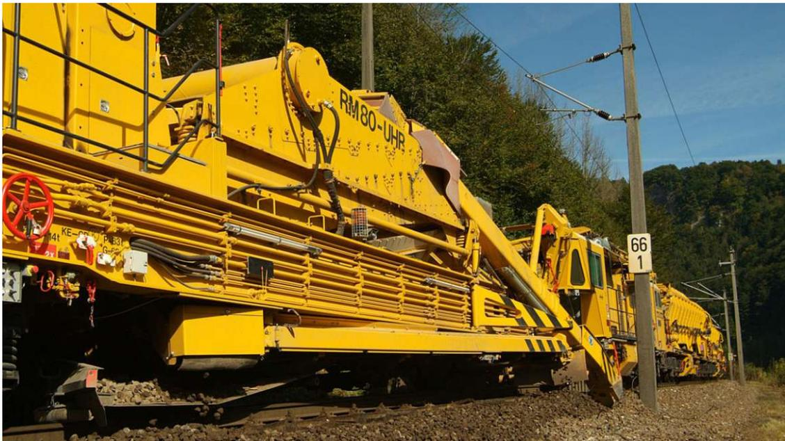
Abbildung 2.3: Standard-Bettungsreinigungsmaschine (RM 80 UHR) mit einer Aushubkette und einer Siebanlage [Plasser & Theurer, 2019]
