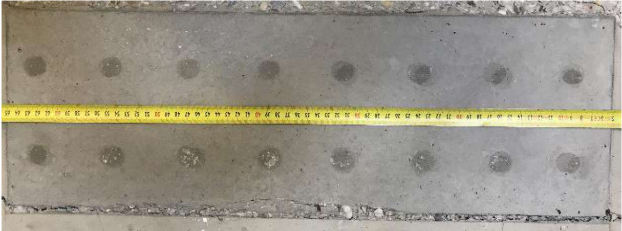
Abbildung 4.19: Abdrücke der Druckstäbe in der Kontaktfläche nach Versuchsdurchführung MT V02
