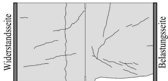
Abbildung C.19: Rissbild Untersicht, RT V02
