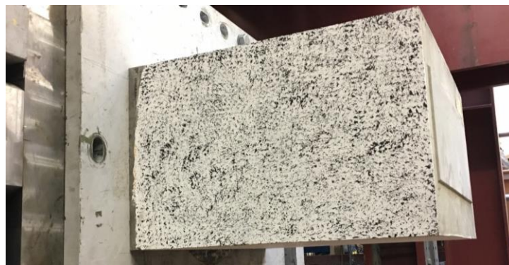
Abbildung 3.8: Tübbing mit stochastischem Muster auf der Belastungsseite
