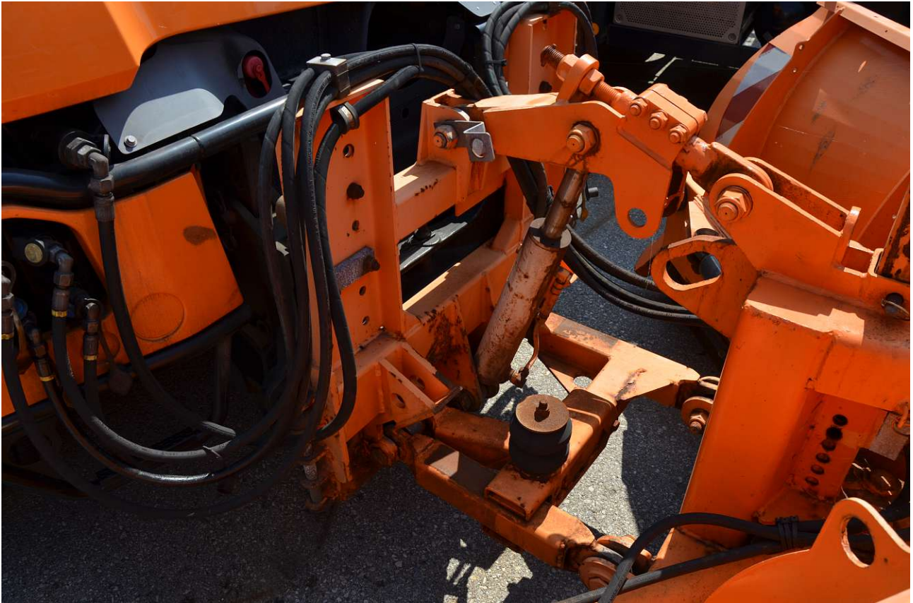
Abbildung 26: Pendelausgleich an einem Schmidt-Pflug
