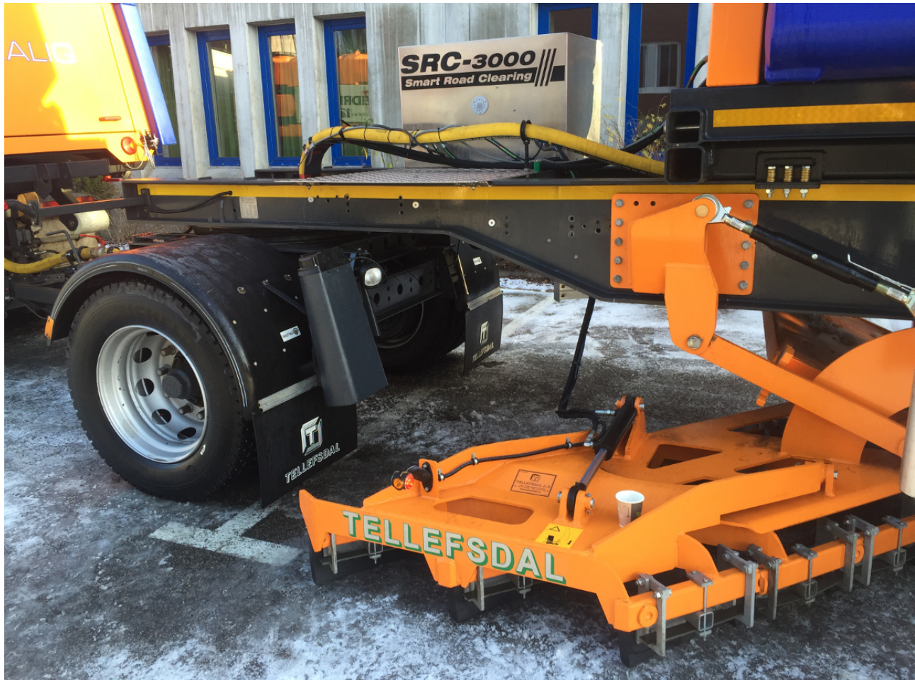
Abbildung 28: Anhänger-Zwischenachslösung von Tellefsdal [31]
