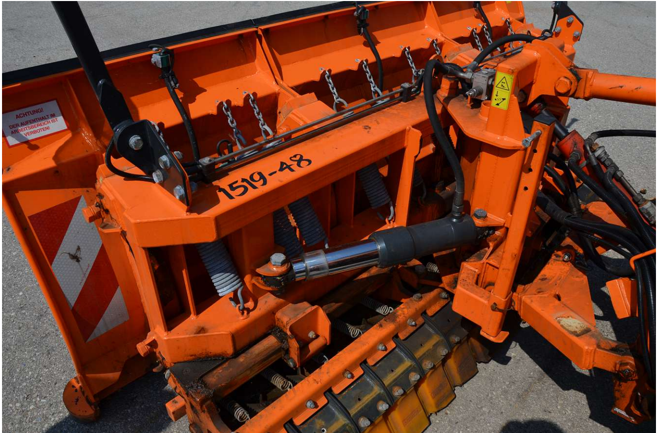
Abbildung 6: Springer SHD mit Nachräumklavier
