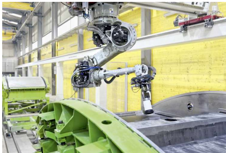
Abb. 2.14: Tübbingroboter der Firma Herrenknecht beim Schalen (Quelle: Englert [20])
