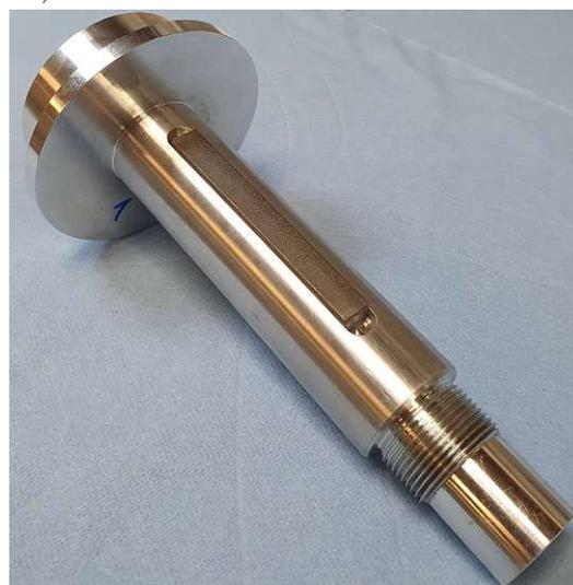
Abbildung A.4: Wellenadapter mit Passfeder
