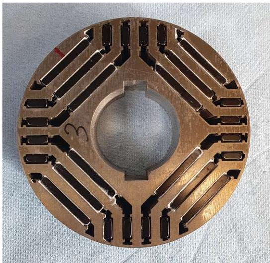
Abbildung A.1: Rotorsegment 3 mit eingesetzten Magneten
