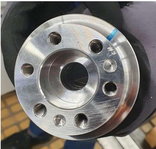
Abbildung A.7: Rotor mit Bohrungen im Wellenadapter nach dem Wuchten
