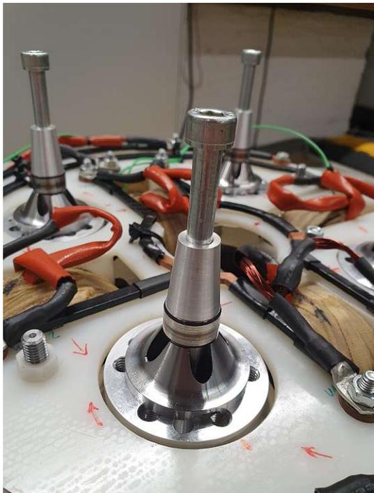
Abbildung A.11: Eingebauter Rotor Aufziehhilfe für das Rotorlager im Deckel
