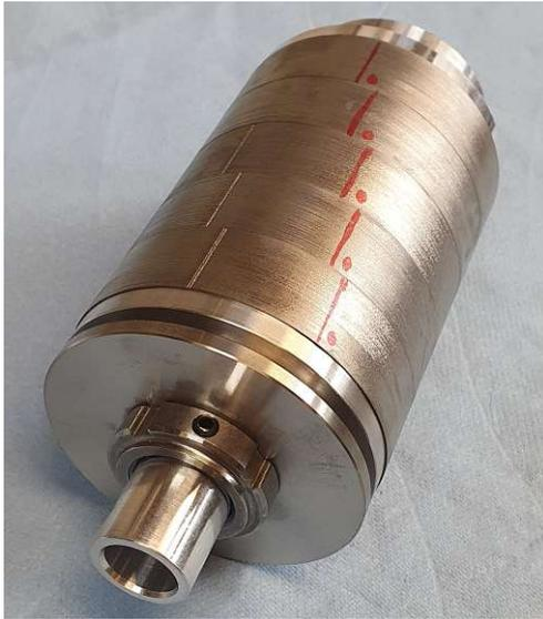
Abbildung A.5: Vollständiger Rotor - Ansicht schmales Wellenende
