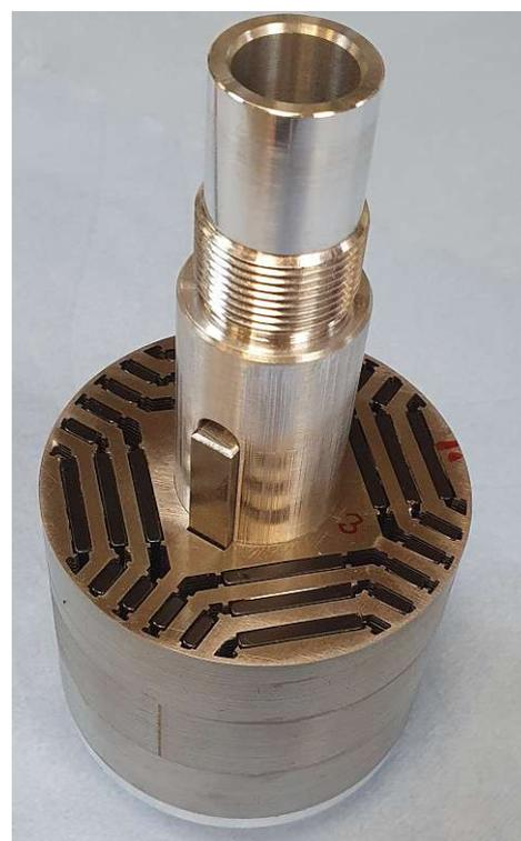
Abbildung A.2: Wellenadapter mit Passfedern und den Segmenten 5, 4, 3 (von unten nach oben)
