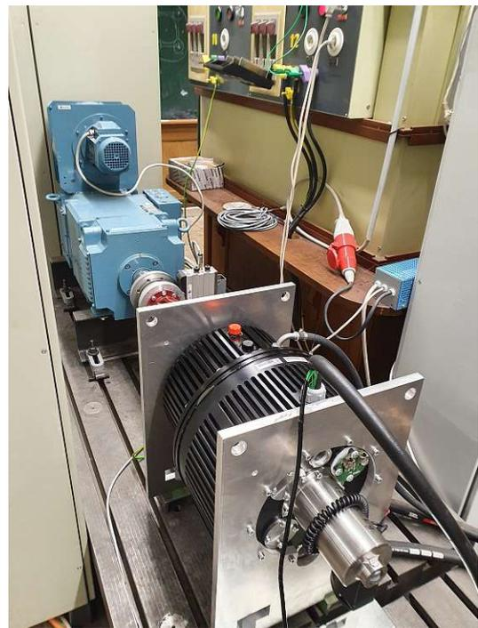
Abbildung A.12: Mit der GSM gekoppelter PM am Maschinenbett
