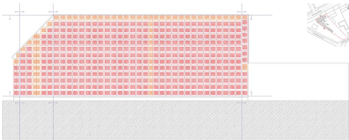
Abbildung 56 Grundmodulanwendung an der Südwestfassade
