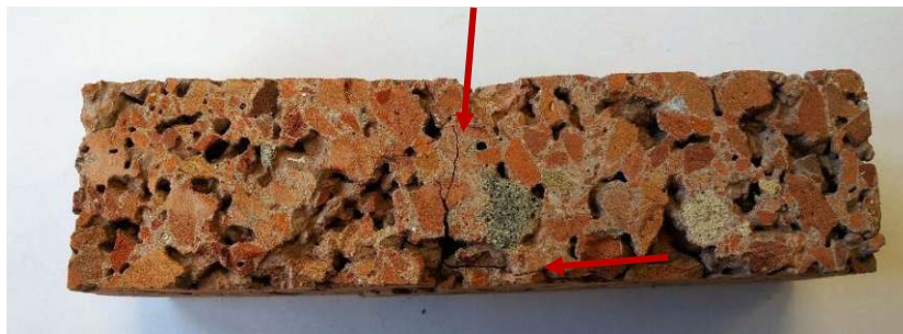
Abbildung 27: Prüfkörper "16E" nach der Biegezugprüfung mit mehreren sichtbaren Rissen in der Bruchfuge; Quelle: Eigene Aufnahme
