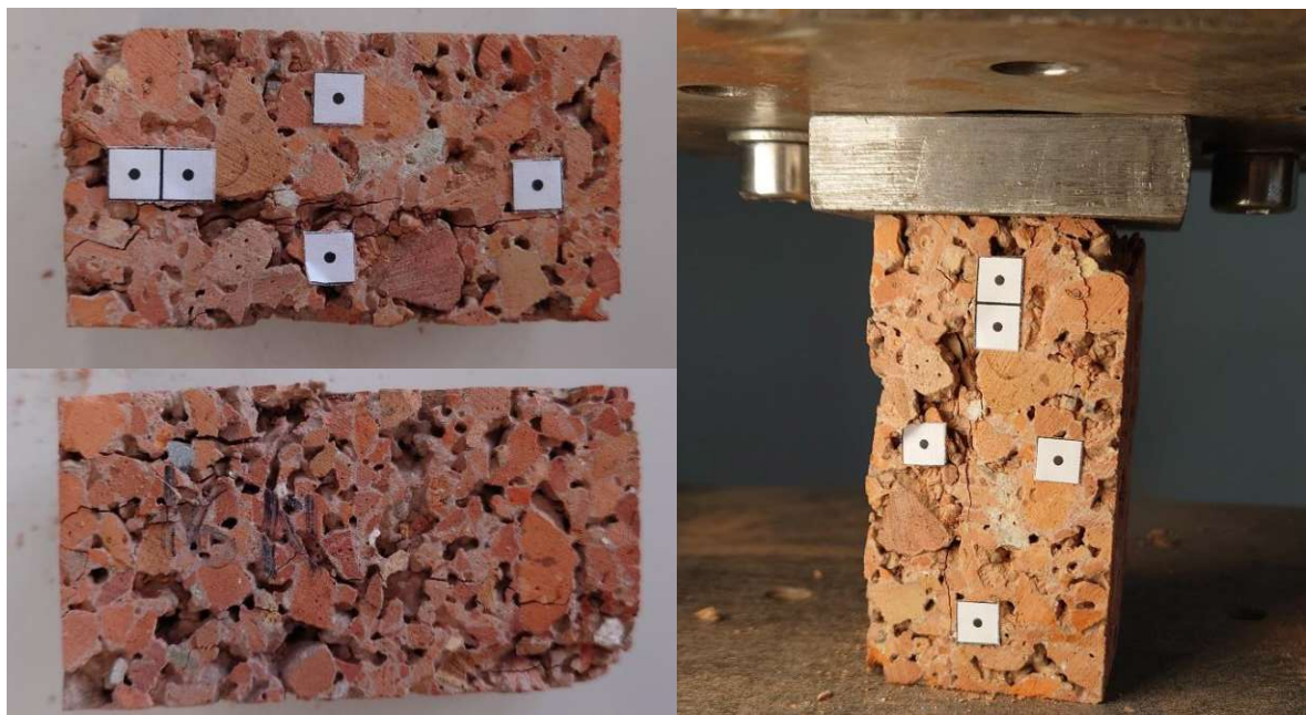
Abbildung 22: Bruchverhalten vom vorgeschädigten Prüfkörper "16N".
