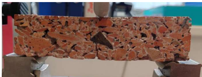
Abbildung 51: Links: Bruchfuge des Prüfkörpers 301K nach dem Biegezugversuch
