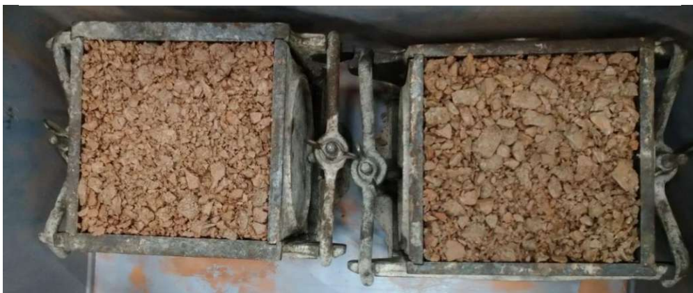
Abbildung 41: Probewürfel Nr. 201 (links) und 202 (rechts) nach dem Betonieren in den Stahlschalungen; Quelle: Eigene Aufnahme
