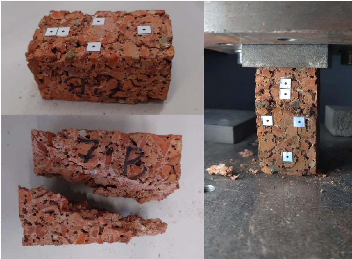
Abbildung 19: Bruchverhalten bei dem Prüfkörper 71B
