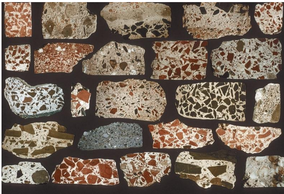
Abbildung 1: Materialproben von Römischen Beton, unter anderem mit Ziegelbruchzuschlag; Quelle: [41]
