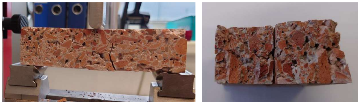
Abbildung 56: Links: Prüfkörper 402K nach dem Biegezugversuch mit dem mittigen Bruch Rechts: Bruchfuge des Prüfkörpers 402K nach dem Biegezugversuch; Quelle: Eigene Aufnahmen
