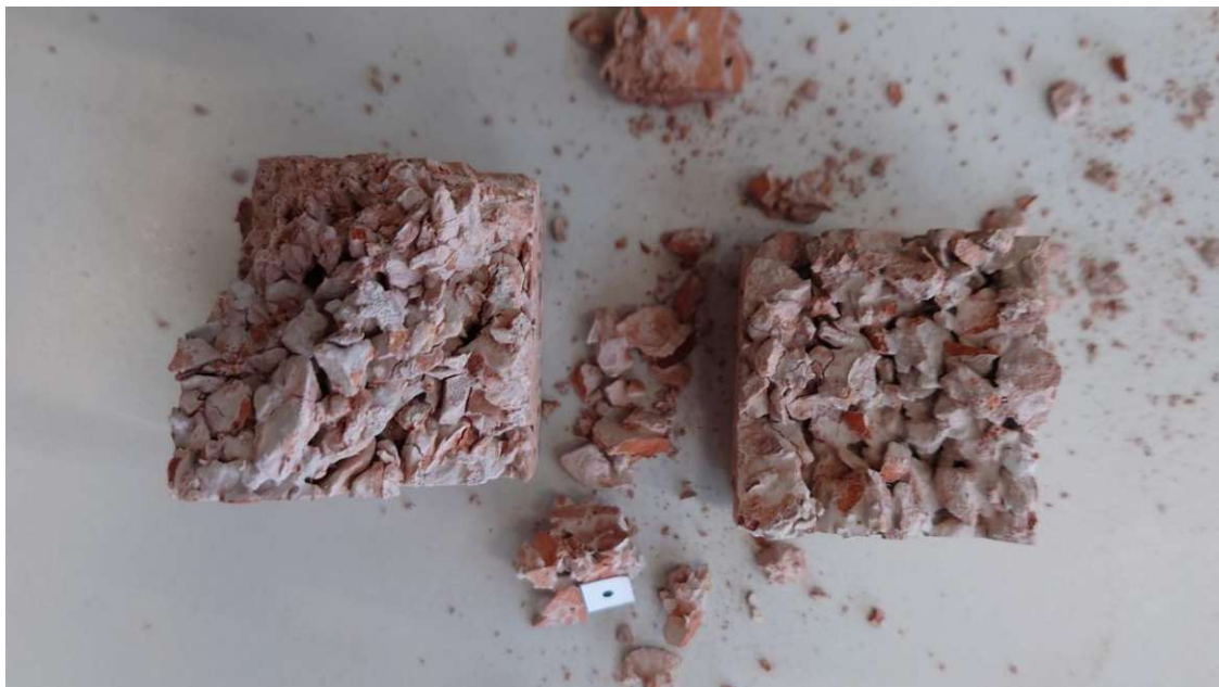
Abbildung 45: Prüfkörper 202B nach der Druckprüfung. Prüfkörper wurde von Hand auseinandergebrochen und die Bruchfuge auf das Bruchversagen hin untersucht;
