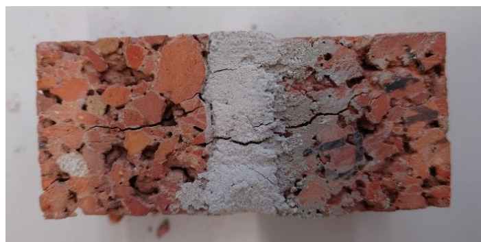
Abbildung 29: Prüfkörper Nr. 6 mit 15 mm Mörtelfuge nach der Druckbelastungsprüfung mit deutlich sichtbaren Rissen durch den gesamten Prüfkörper; Quelle: Eigene Aufnahme
