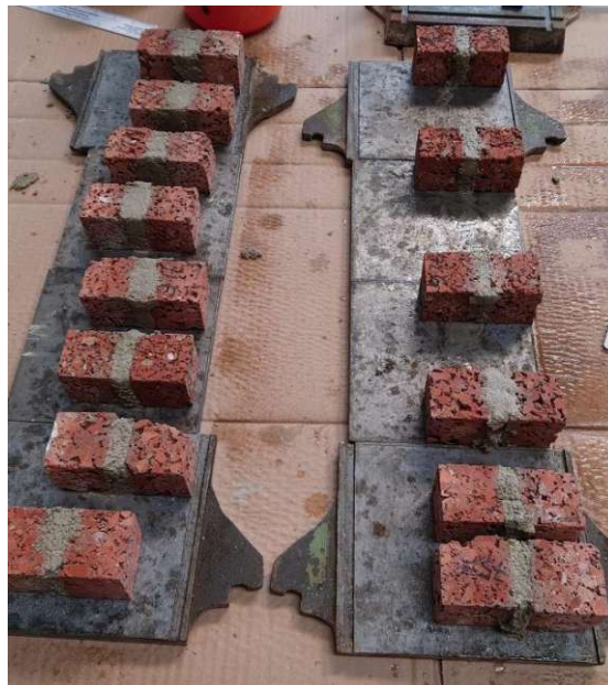
Abbildung 28: Fertig vorbereitete und vermörtelte Prüfkörper
