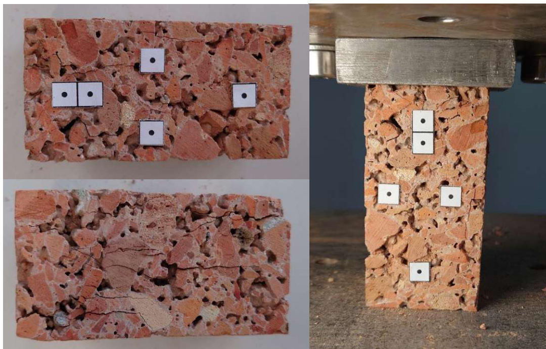
Abbildung 23: Bruchverhalten vom vorgeschädigten Prüfkörper "16Q"
