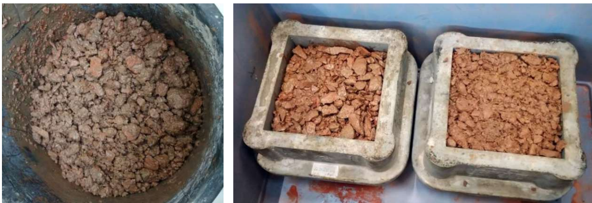
Abbildung 35: Links: Ziegelsplittbeton der Serie 1 nach dem Anmischen
