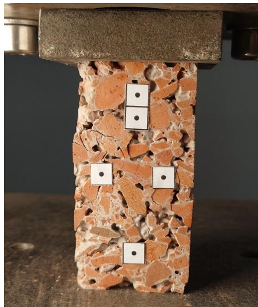
Abbildung 49: Prüfkörper 301F nach der Druckfestigkeitsprüfung; Quelle: Eigene Aufnahme
