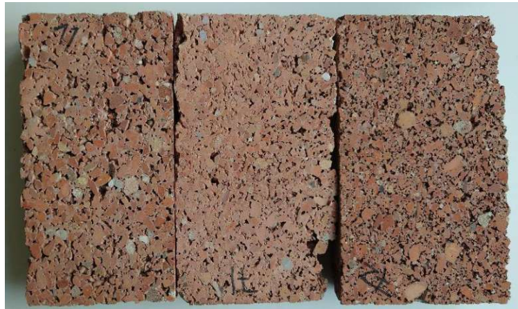
Abbildung 9: Vergleich der Querschnittsflächen (von den Stirnseiten) der Steine 11, 71 und 72 mit unterschiedlichen Sieblinien: grob (links, Stein 11), mittel (Mitte, Stein 71) und fein mit einzelnen großen Körnern (rechts, Stein 72); Quelle: Eigene Aufnahme
