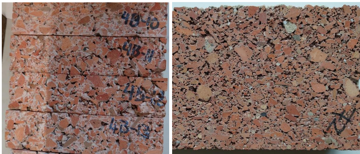
Abbildung 54: Links: Probserie 402 im Querschnitt. Hier die Schnittfläche unterhalb der stabförmigen Biegezugprüfkörper.
