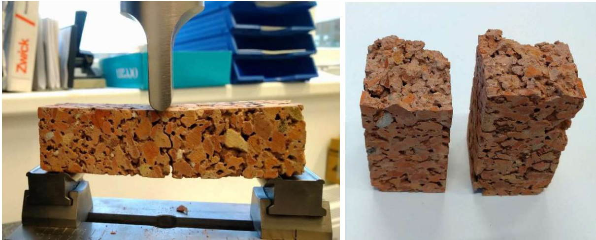
Abbildung 25: Bruchbild von Prüfkörper "71J" unter Biegezugbelastung;
