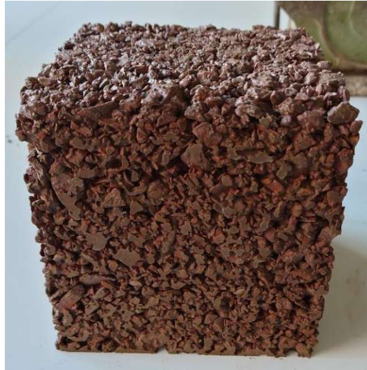
Abbildung 53: Probewürfel 401 nach dem Ausschalen; Quelle: Eigene Aufnahme
