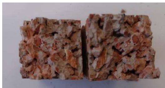
Abbildung 51: Links: Bruchfuge des Prüfkörpers 301K nach dem Biegezugversuch
