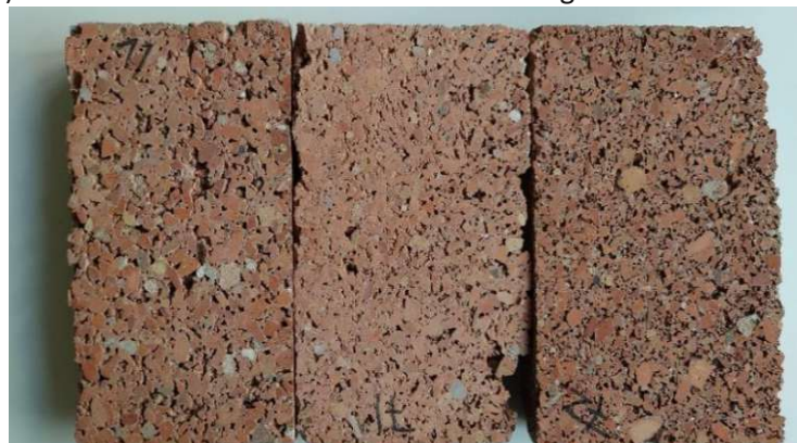
Abbildung 58: Vergleich der drei Korngrößenzusammensetzungen der Vibrosteine von grob (links, Nr. 11) über mittel (Mitte, Nr. 71) zu fein (rechts, Nr. 72);
