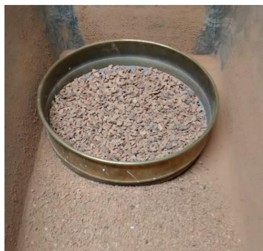
Abbildung 33: Siebung des selbstgebrochenen Ziegelsplitts; Quelle: Eigene Aufnahme
