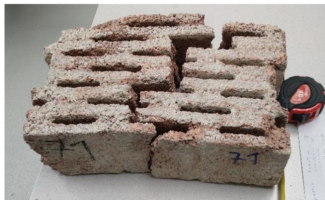
Abbildung 7: Zustand vom Vibrostein (Probennummer 71) nach dem 3-Punkt-Biegezugversuch; Quelle: Eigene Aufnahme
