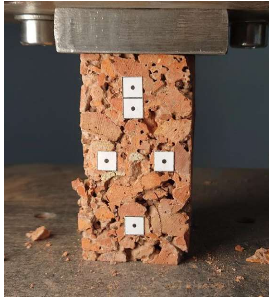
Abbildung 20: Prüfkörper „74G“ mit einzelnen Abplatzungen nach der Druckfestigkeitsprüfung im unteren Bereich Quelle: Eigene Aufnahme
