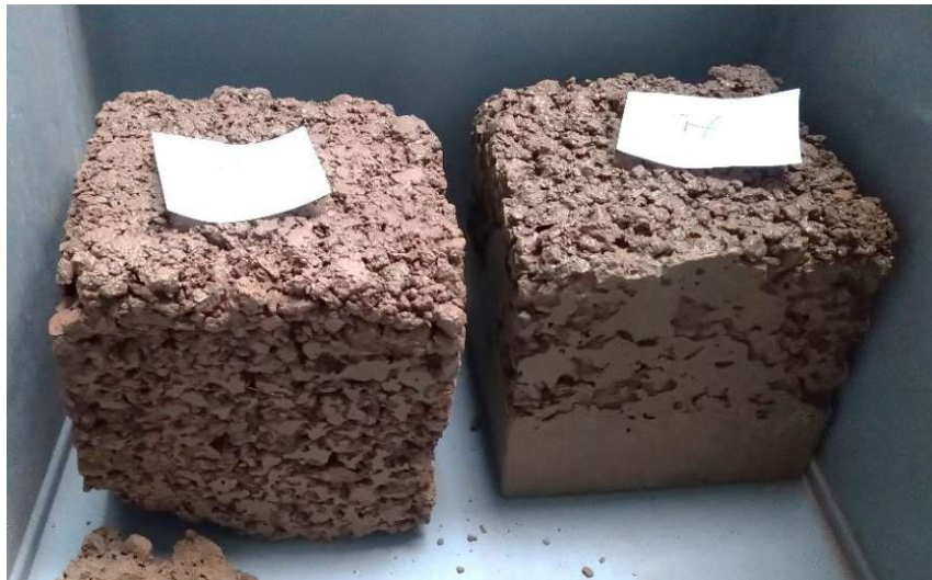
Abbildung 36: Probewürfel 102 (links) und 101 (rechts) nach dem Ausschalen;
