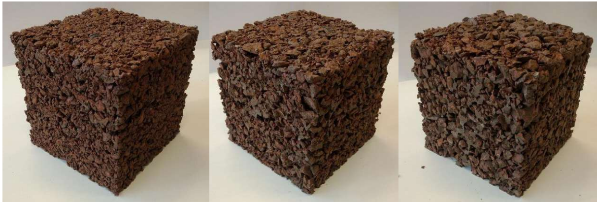
Abbildung 42: Probewürfel der Serie 2 nach dem Ausschalen. Die drei Sieblinien sind auch von außen deutlich erkennbar.
