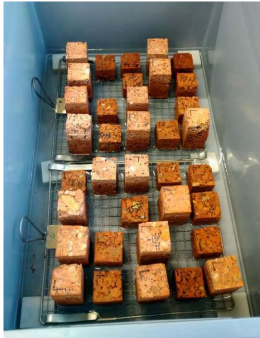
Abbildung 13: Prüfkörper auf dem Gitterrost während des Wasseraufnahmeversuchs; Quelle: Eigene Aufnahme
