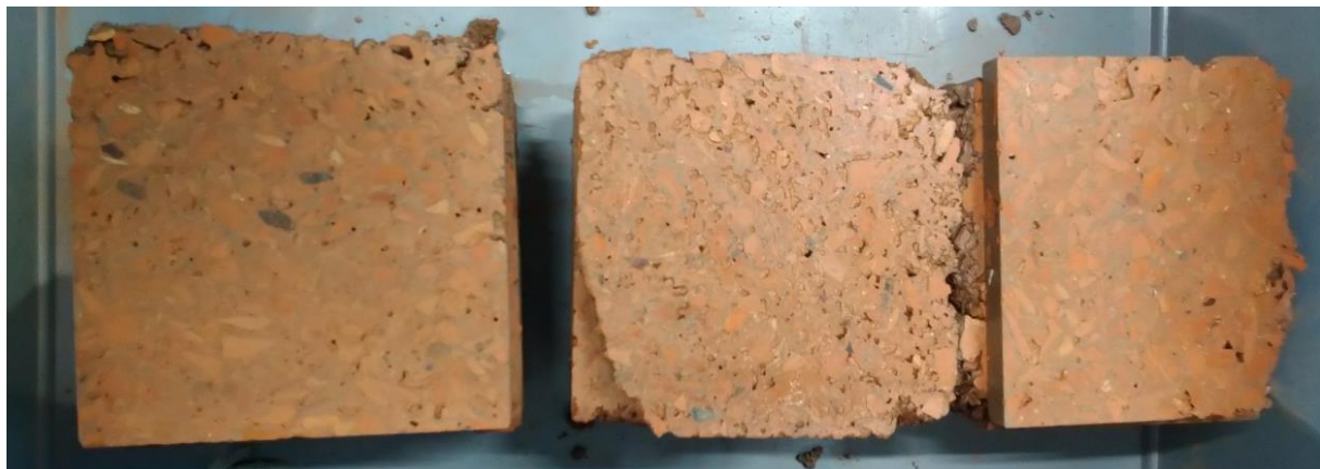
Abbildung 37: Querschnitt durch die drei Proben der Serie 1. Links: 101, Mitte: 102, Rechts: 103;
