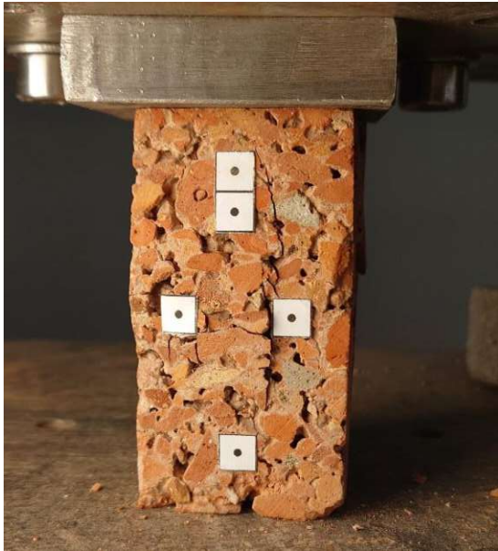
Abbildung 21: Prüfkörper „74F“ ist nach der Druckfestigkeitsprüfung in der Mitte gestaucht; Quelle: Eigene Aufnahme
