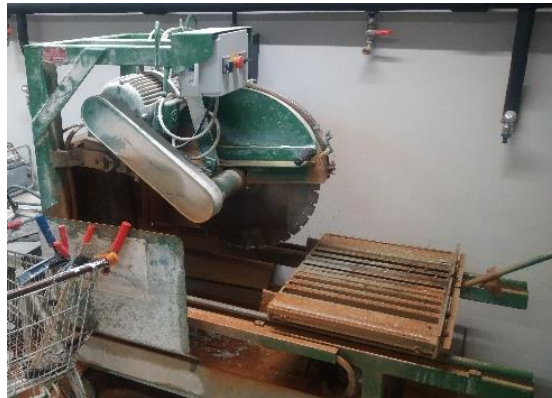
Abbildung 8: Steintrennmaschine für den Zuschnitt der Kleinprüfkörper; Quelle: Eigene Aufnahme
