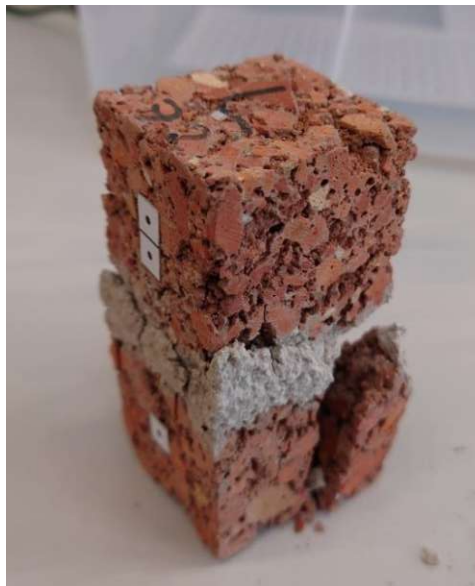
Abbildung 30: Prüfkörper 11 mit 10 mm Mörtelfuge nach der Druckbelastungsprüfung mit großen Abplatzungen am unteren Ziegelsplittbetonwürfel und dem Mörtel; Quelle: Eigene Aufnahme
