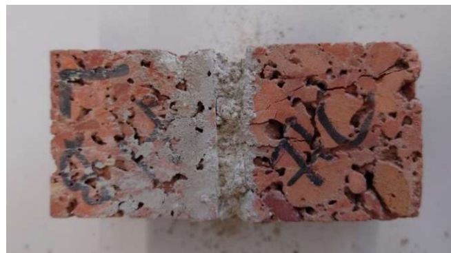
Abbildung 31: Prüfkörper 5 mit klar erkennbarer Stauchung der vormals 15 mm starken Mörtelfuge auf nur noch ca. 8 mm; Quelle: Eigene Aufnahme
