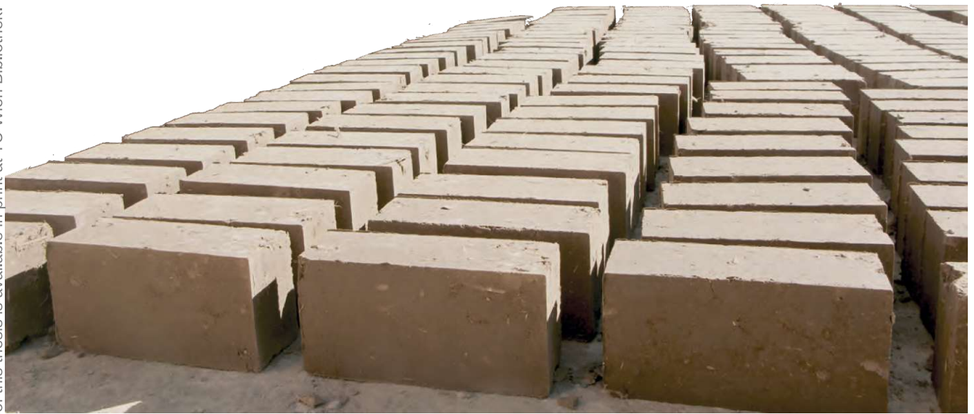
Abb. 1 Herstellung von Lehmziegeln (© C. Hörburger).
