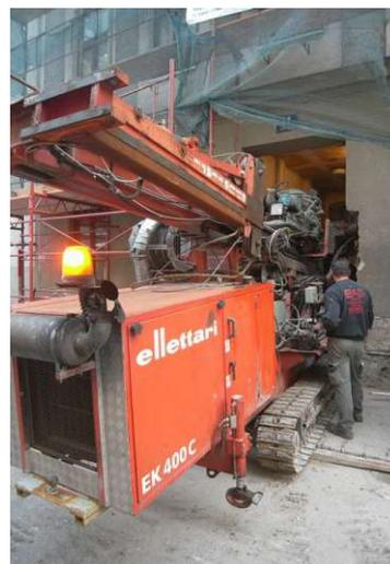
Abb. 83: Bohrergerät der Geothermie und dessen enger Zugang (www.proholz.at/fileadmin/proholz/media/proHolz\_Projekte/Webinare/Webinare/2020/proHolz-Webinar-2-2020-Modull-Zeinger.pdf)
