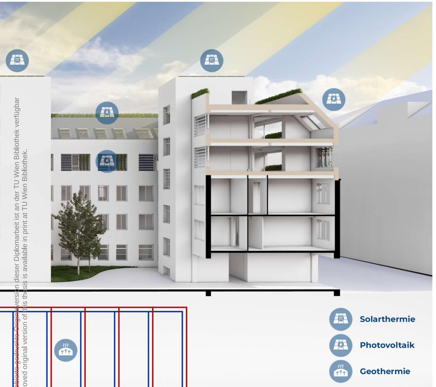
Die Be- und Entlüftung der Aufstockung erfolgt über eine natürliche Querlüftung, wodurch keine energieintensiven Klimaanlage benötigt werden. Die Einhaltung gegen sommerliche Überwärmung wird in einem späteren Abschnitt näher aufgegriffen.
