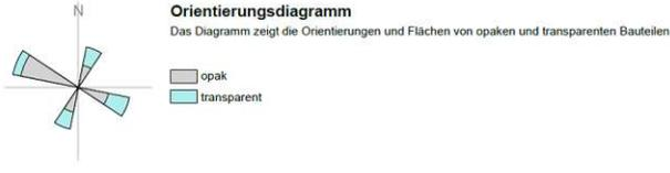
Abb. 181: Orientierung und Flächen transparenter und opaker Bauteile der Aufstockung (Eigene Darstellung)
