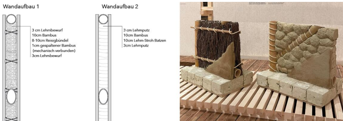
Abbildung 204: Alternative Wandaufbauten (Quelle: Windisch, 2023)
