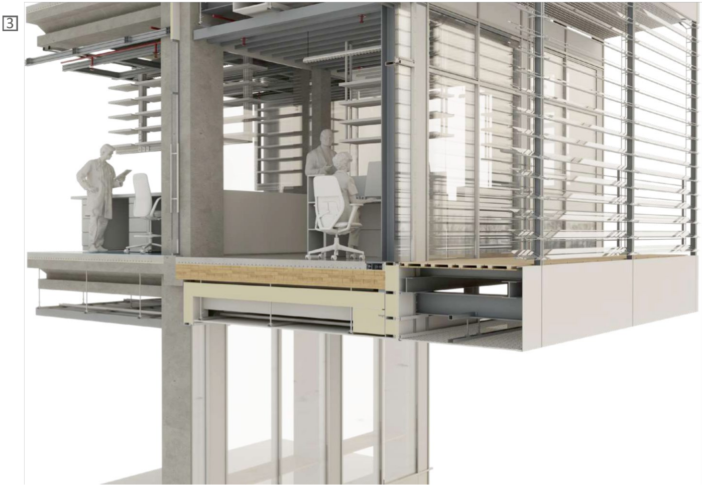
Abbildung 5.22: Konstruktionsdarstellung iim Bereich Auskrugung als dreidimen- sionale Darstellung, Eigene Abbildung
