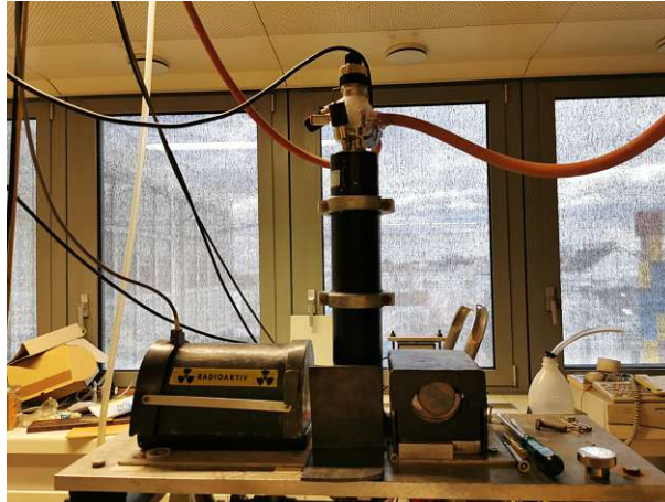
Abbildung 7: Foto des verwendeten Mössbauerspektrometers
