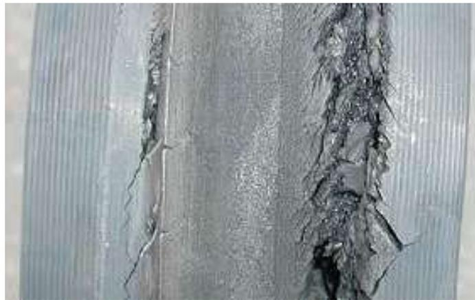
Abbildung 1-1: Links: Seilbahnrolle, bestehend aus Rollenkörper (Metallnabe und Seitenscheiben) und Gummieinlagering [19]; Rechts: Durch thermisch-oxidative Alterung verursachte Rissbildung an der Oberfläche eines Seilbahneinlagerings [41]
