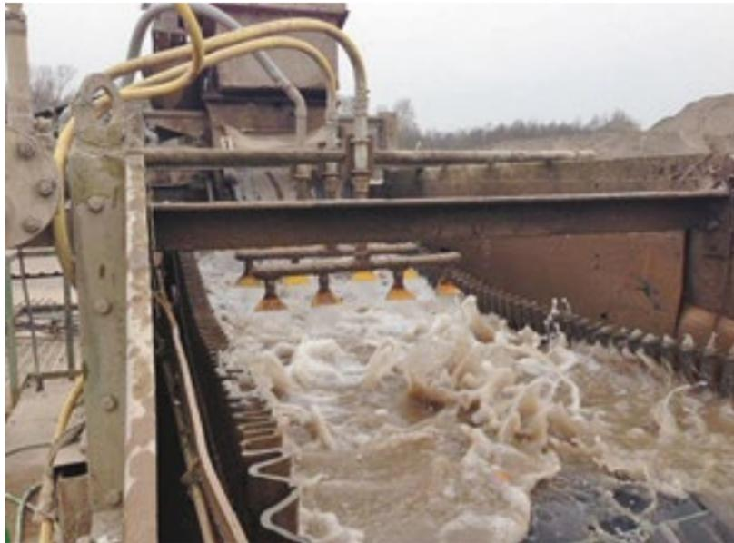
Abb. 3.18: Ausführungsbeispiel eines Hydroabscheiders. (Quelle: Müller [36, S. 115])
