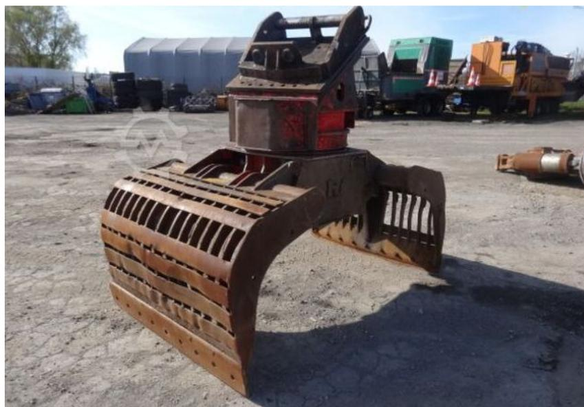
**Abb. 3.1:** Mechanisch starrer Abbruchgreifer (Quelle: Machineseeker [32])
