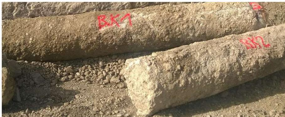
**Abb. 5.4:** Ausgegrabene Kiespfähle B.K1 und B.K2 (Foto: ARGE – FPUH)
