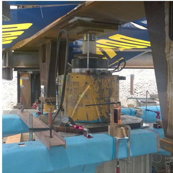
**Abb. 5.7:** Hydraulische Presse der Belastungseinrichtung (Foto: ARGE – FPUH)
