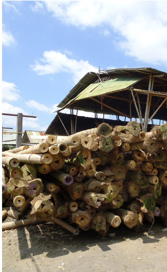
Abb. 12, 13 Beispiele schadhafter Bambushalme
