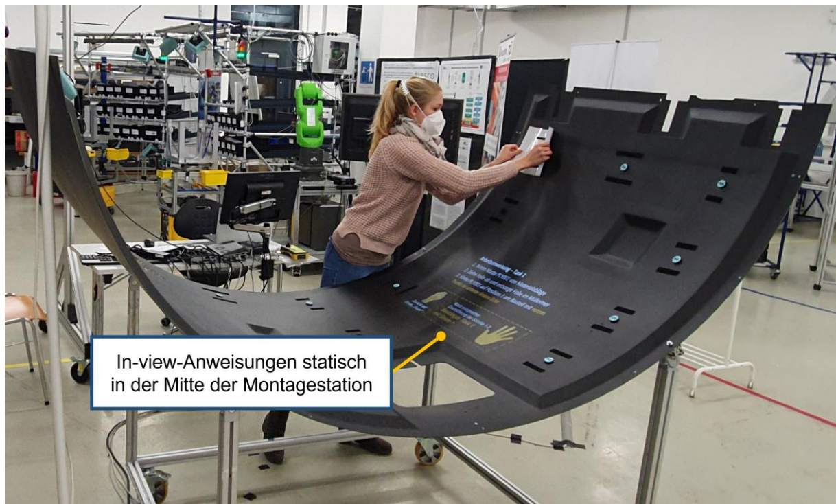
Abbildung 88 | In-view-Projektion in der Fan-Cowl-Montage (Eigendarstellung)
