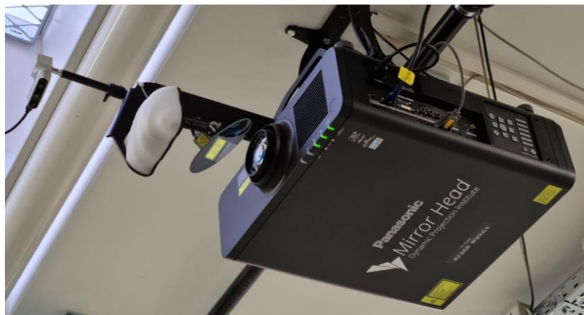
Abbildung 80 | Full-HD+ Projektor mit digital steuerbarem Spiegelsystem (Eigendarstellung)
