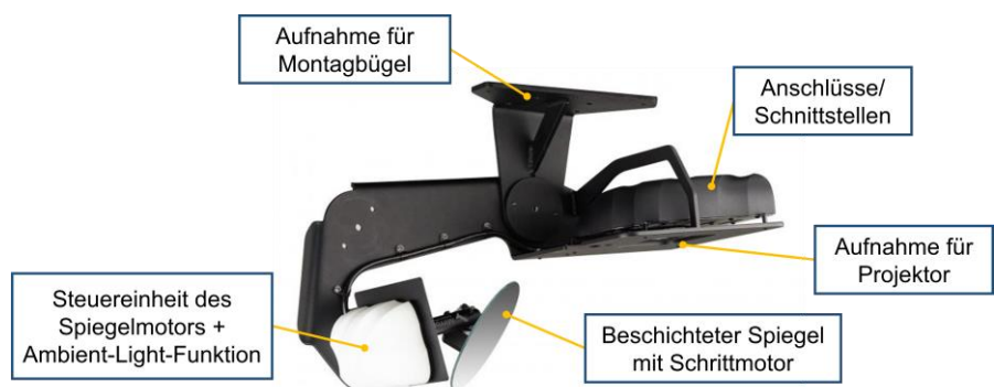
Abbildung 46 | Mirror-Head zur dynamischen Projektion, in Anlehnung an Dynamic Projection Institut GmbH (2020a)
