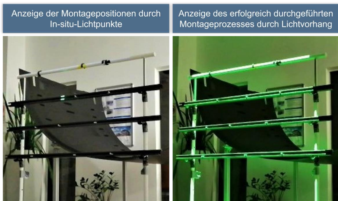
Abbildung 91 | Anzeige der Montageposition durch Lichtpunkte und Lichtvorhang bei erfolgreicher Durchführung (Eigendarstellung)
