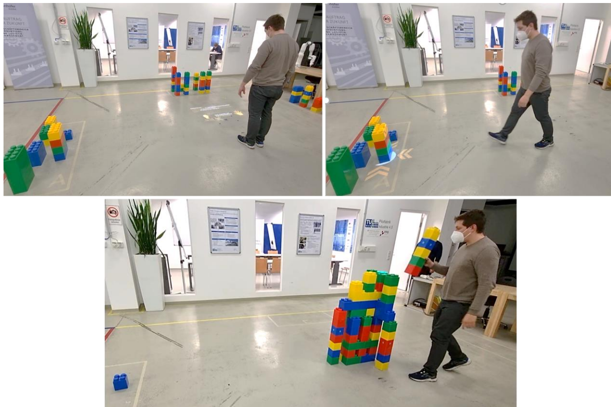
Abbildung 92 | In-situ-Projektion und Informationsführung zur Entnahme- und Montageposition bei der Spielbaustein-Montage (Eigendarstellung)
