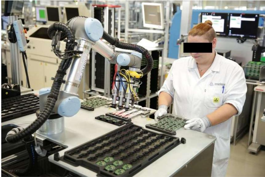
Abbildung 45: Industriell implementiertes Arbeitssystem zur Platinenverpackung
