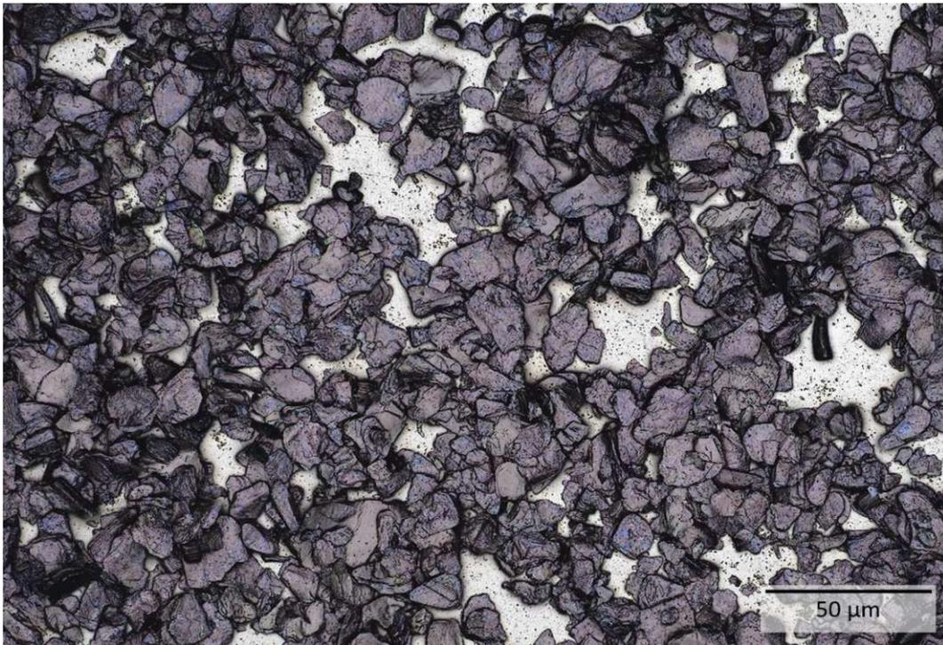
**Abbildung 19:** Mikroskopische Aufnahme Stahlsubstrat (1.4301) mit  $\text{Ti}_3\text{C}_2\text{T}_x$ -Beschichtung, hergestellt mittels Airbrush (Top-view, 50-fache Vergrößerung, Aufnahmemodus: Laser + Optisch)
