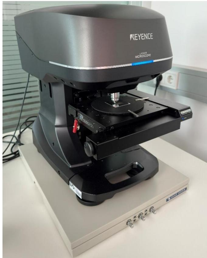
**Abbildung 14:** Verwendetes Laserscanning-Mikroskop mit entsprechend platzierter Probe
