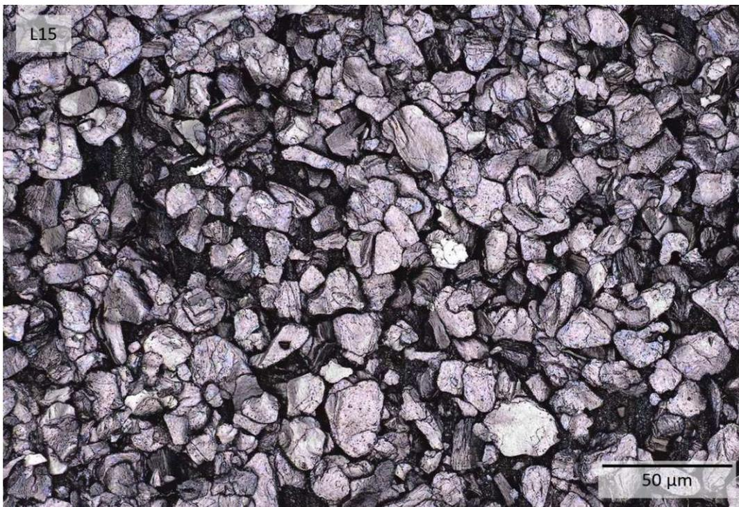
**Abbildung 27:** Mikroskopische Aufnahme laserstrukturierter TiAl6V4 Oberfläche mit Linienmuster (Periode 15  $\mu\text{m}$ ) und  $\text{Ti}_3\text{C}_2\text{T}_x$ -Beschichtung (Top-view, 50-fache Vergrößerung, Aufnahmemodus: Laser + Optisch)
