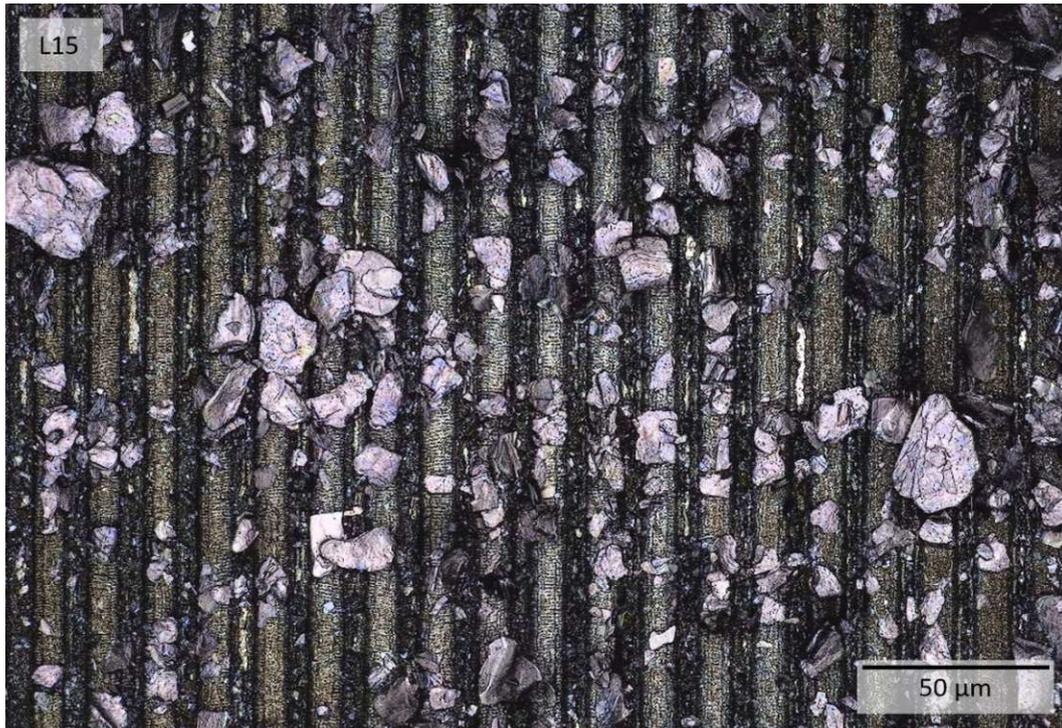
**Abbildung 22:** Mikroskopische Aufnahme laserstrukturierter Stahl (1.4301) Oberfläche mit Linienmuster (Periode = 15  $\mu m$ ) und  $Ti_3C_2T_x$ -Beschichtung (Top-view, 50-fache Vergrößerung, Aufnahmemodus: Laser + Optisch)
