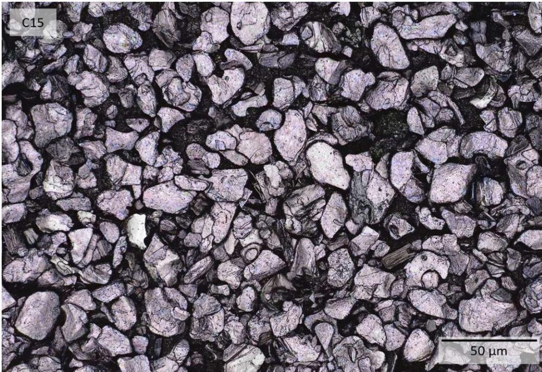
**Abbildung 28:** Mikroskopische Aufnahme laserstrukturierter TiAl6V4 Oberfläche mit Kreuzmuster (Periode 15  $\mu\text{m}$ ) und  $\text{Ti}_3\text{C}_2\text{T}_x$ -Beschichtung (Top-view, 50-fache Vergrößerung, Aufnahmemodus: Laser + Optisch)
