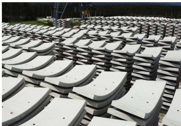
(a) Tübbinglager für den Semmering-Basistunnel © ÖBB
