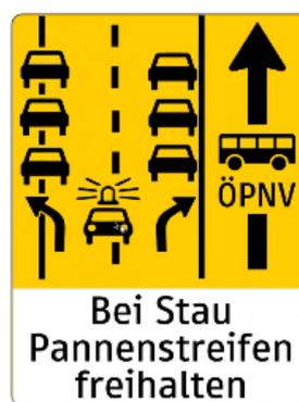
Abbildung 42: Beschilderung der Pannestreifennutzung durch ÖV in Baustellenbereichen auf der A 10, Quelle: ASFINAG 2024b
