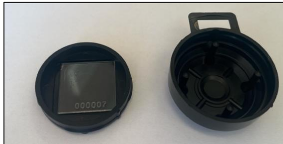
Abb. 27: zweiteiliges offenes Kunststoffgehäuse und Kunststoffdetektor 000 007
