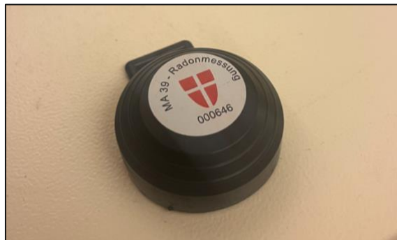
Abb. 28: geschlossenes Exposimeter mit sechsstelliger Identifikationsnummer 000 646
