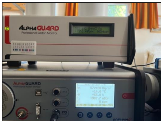
Abb. 9: AlphaGuard P30 (oben) und AlphaGuard DF2000 (unten)
