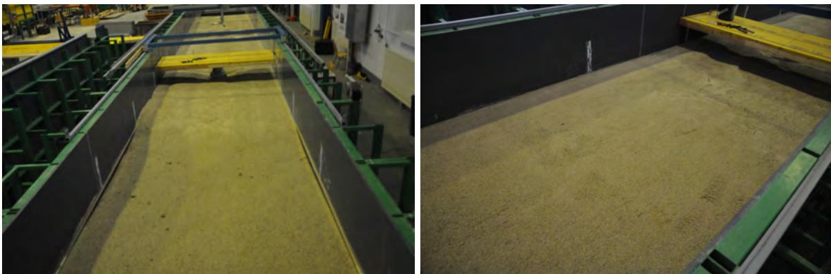
(a) Erosion im Bereich Rampe Unterkonstruktion      (b) Sohle nach Reparatur wiederhergestellt
