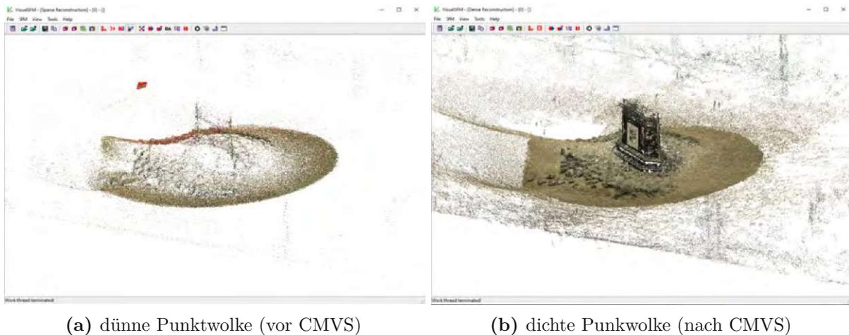
**Abb. 2.14:** Unterschied in der Punktdichte des 3D-Modells vor und nach Verwendung von Clustering View for Multi-view Stereo (CMVS); Verwendetes Programm: VisualSFM(Wu et al.) mit CMVS(Furukawa et al.)
