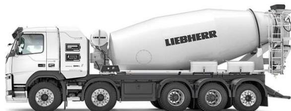
**Abb. 2.8:** Der elektrische Liebherr Betonmischer ETM 1205 wurde gemeinsam mit der Firma Futuricum entwickelt [39]
