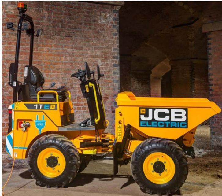
Abb. 2.12: Vollelektrischer Raddumper ITE der Firma JCB [29]
