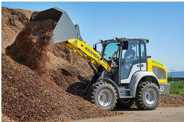
**Abb. 2.14:** Wacker Neuson elektrischer 5055e allradgelenkter Radlader [67]
