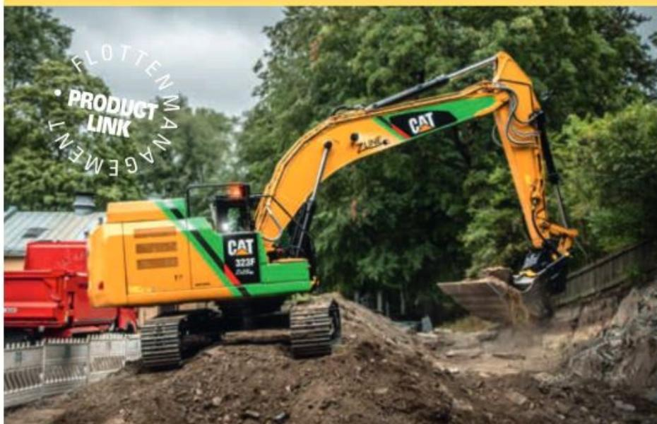
Beim Kettenbagger 323F ZLine wurden Dieselmotor, Tank und Kontergewicht durch Elektromotor, Batteriemodul, Ladegerät und Steuergeräte ersetzt. Der batteriebetriebene 25-Tonnen-Hydraulikbagger wurde vom norwegischen Cat-Händler PON in enger Zusammenarbeit mit Caterpillar entwickelt und hat sich bereits im Praxiseinsatz bei einigen Kunden in Norwegen bewährt.
