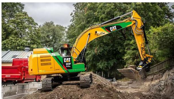
Abb. 2.3: Der Caterpillar Elektrobagger Typ 323F Z-Line [79]
