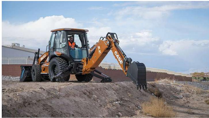
Abb. 2.9: Baggerlader 580 der Firma Case Construction Equipment [10]
