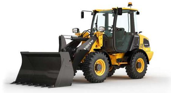
Abb. 2.13: Der 5,0 t Kompaktlader L25-electric der Firma Volvo [60]
