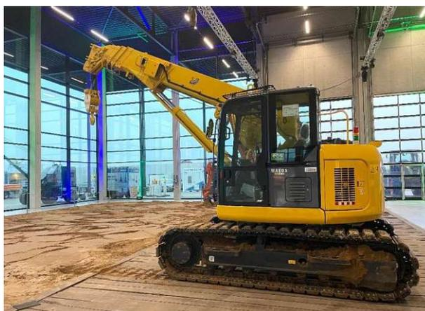
Abb. 2.17: Maeda Kran CC 1485, welcher mit einem vollelektrischen Antrieb der Firma Deutz ausgestattet wurde [17]
