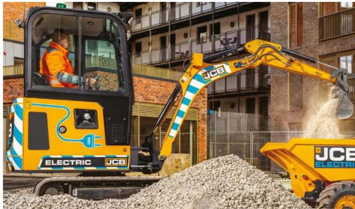
**Abb. 2.5:** Der vollelektrische Bagger 19C-1E der Firma JCB [30]
