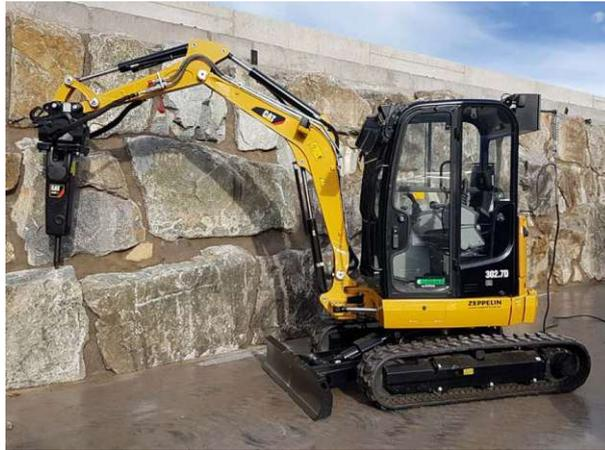
**Abb. 2.4:** Der Caterpillar Elektrobagger- Minibagger Typ 302.7D CR [12]
