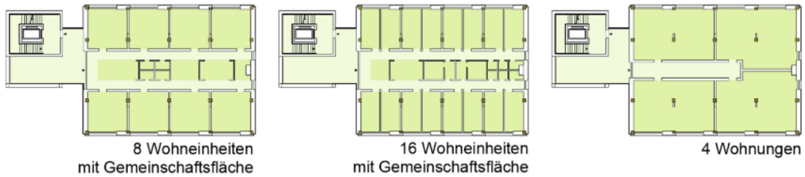
Abbildung 4-8: Flexible Grundrissgestaltung durch nicht tragende Innenwände (aus [26])
