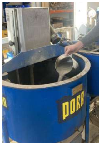
Abb. 4.18: Injektionsmörtel nach dem 3 Minuten langen Mischen
