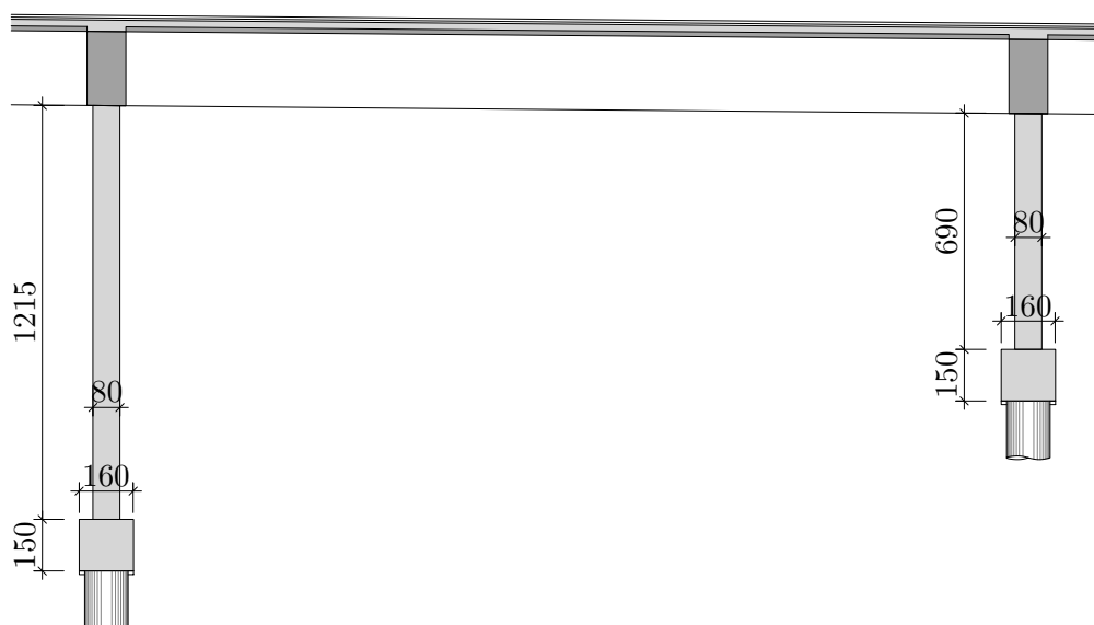
Abb. 3.16: Pfeiler der Brücke über die B37 bei Krems für die LT-Brücken Variante
