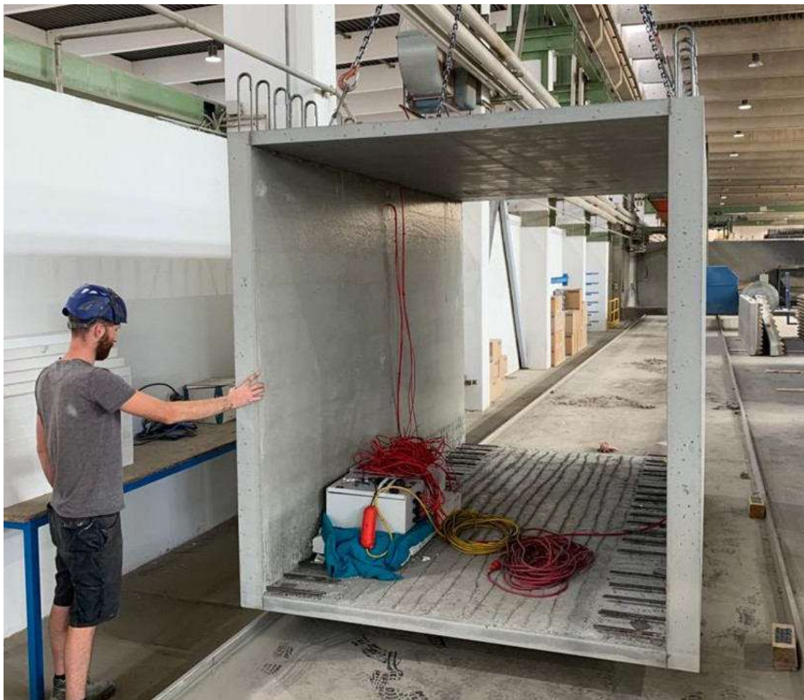
Abb. 3.2: Mock-up eines Fertigteilelements für den Träger in longitudinaler Richtung (Foto: TU Wien)
