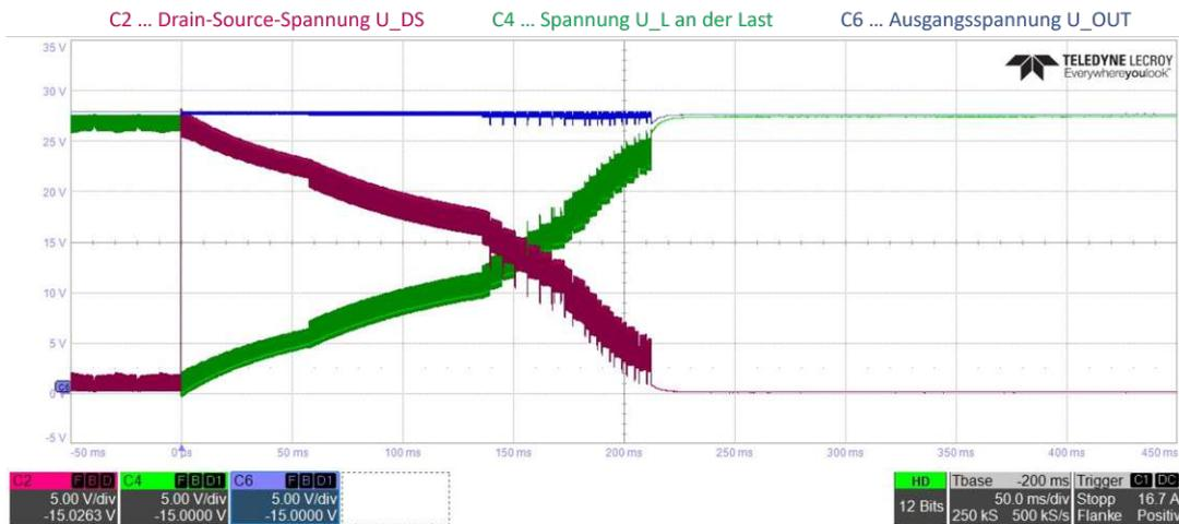
Abbildung 5.5: Einschaltvorgang Messung 3 Spannungen
