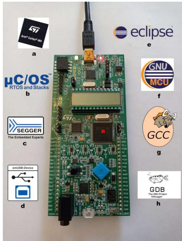
Abbildung 4.1: Development Board von STM mit STM32L476VG. Logos der verwendeten Systeme (a [96], b [88], c [97], d [98], e [99], f [100], g [101], h [102])
