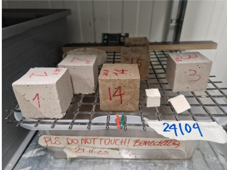
Abbildung 20: Lagerung der NHL-Probewürfel auf einem Gitterträger zur Gewährleistung einer allseitig gleichmäßigen Karbonatisierung in der Klimakammer bei 20°C und 60,5% rF
