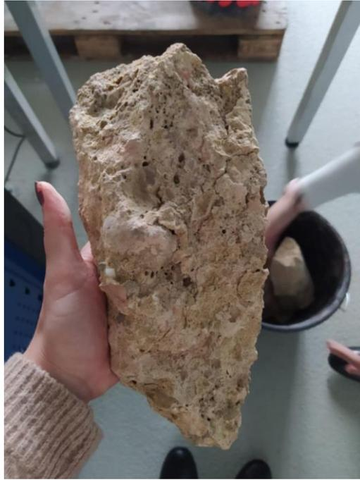
Abbildung 12: Bohrkern aus dem Gebäude Kärntner Ring 8 bestehend aus einer betonartigen Matrix
