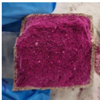
Abbildung 28: Karbonatisierungstest mit Phenolphthalein eines NHL-Probewürfels mit einem Probenalter von 7 Tagen (pinker Bereich = nicht karbonatisierter Bereich, grauer Bereich = karbonatisierter Bereich)
