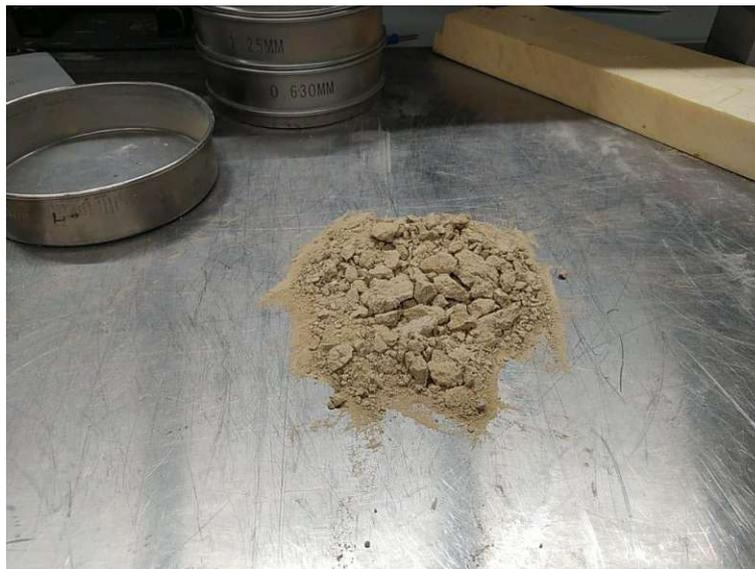
*Abbildung 15: abgeklopfter alter Mörtel des Bohrkerns*
