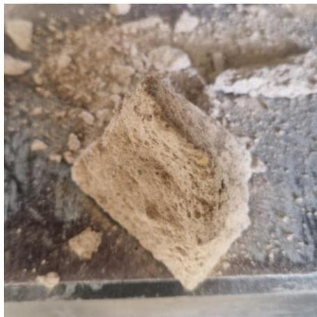
Abbildung 25: völlig karbonatisierter NHL-Probewürfel mit einem Alter von 95 Tagen nach dem Druckversuch
