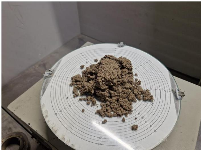
Abbildung 17: Ausbreitversuch der NHL-Mörtelmischung mit einem W/B-Wert von 0,70
