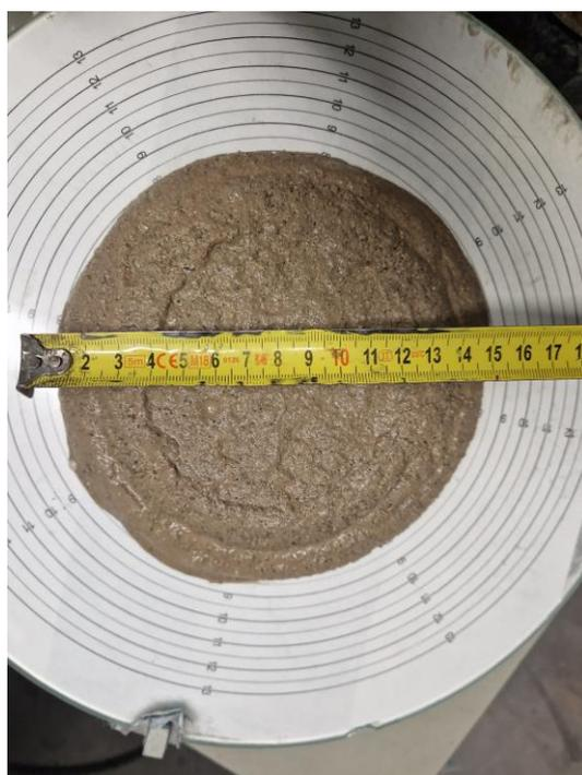
Abbildung 18: Ausbreitversuch der NHL-Mörtelmischung mit einem W/B-Wert von 0,90
