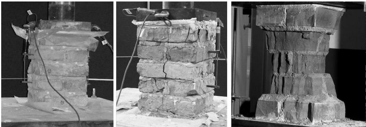
Abbildung 7: Prüfpfeiler aus Vollziegelmauerwerk<sup>33</sup>
