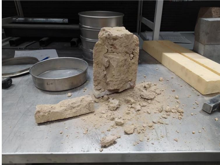
*Abbildung 14: händische Trennung des alten Mörtels von den Ziegeln des Bohrkerns mittels Hammer und Meisel*
