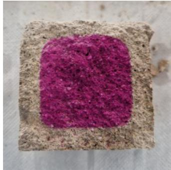
Abbildung 27: Karbonatisierungstest mit Phenolphthalein eines NHL-Probewürfels mit einem Probenalter von 28 Tagen (pinker Bereich = nicht karbonatisierter Bereich, grauer Bereich = karbonatisierter Bereich)
