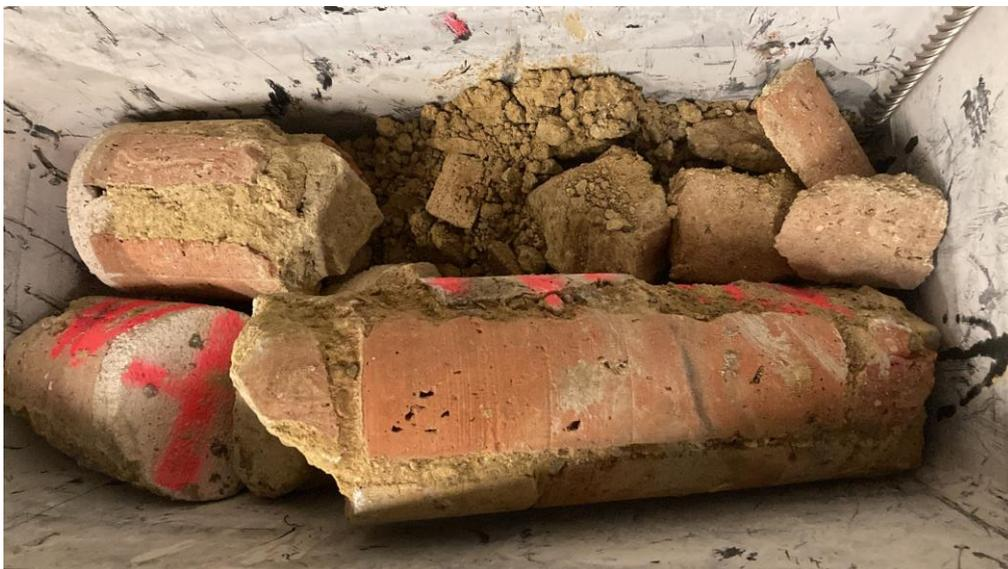
Abbildung 13: entnommener Bohrkern aus dem Gebäude Neutorgasse 56, 8010 Graz
