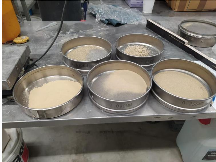
Abbildung 16: zerkleinertes & anschließend gesiebtes altes Mörtelmaterial
