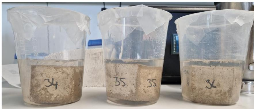
Abbildung 23: mit Parafilm verschlossene Behälter mit den allseitig in Wasserglas getränkten NHL-Proben
