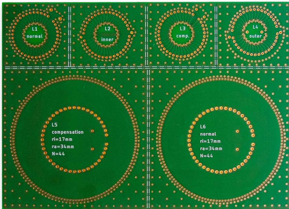
Abbildung 22: Platine mit den sechs Spulendesigns L1 bis L6
