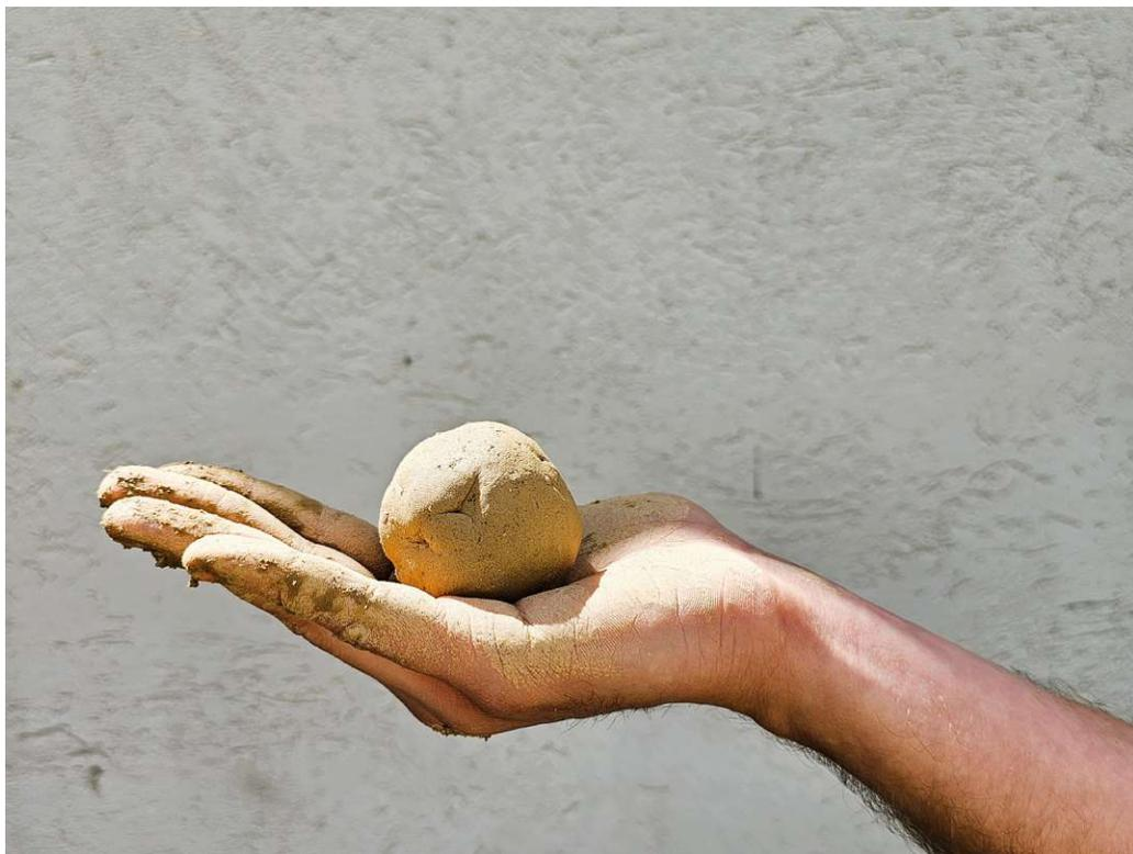
46 FOTO: KUGELFALLPROBE: FALLENLASSEN AUF GLATTE OBERFLÄCHE
