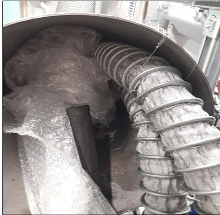
Abbildung 39: Absaugung des Abgasstromes des CFR-Prüfmotors am IFA der TU Wien (minimaler Gegendruck)
